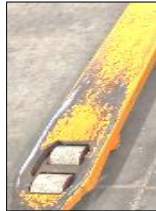
Figura 39. Ruedas del transpaleta en mal estado
