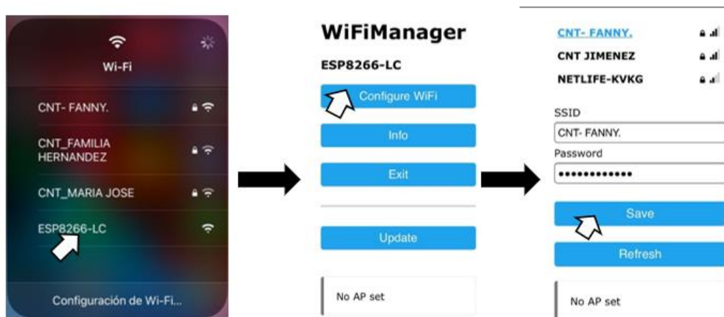
Figura 63. Conexión del sistema de monitoreo a la red local
