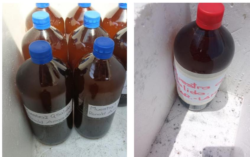
**Figura 26.** Conservación y transporte de muestras recogidas de la PTAR
