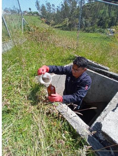
**Figura 24.** *Recolección de muestra de entrada de agua residual de la PTAR*
