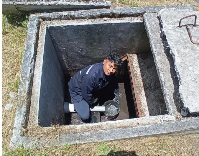
**Figura 22.** *Medición del caudal de ingreso a la PTAR*
