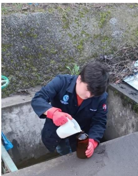
*Figura 9. Recolección de las muestras de agua residual obtenidas en la PTAR*
