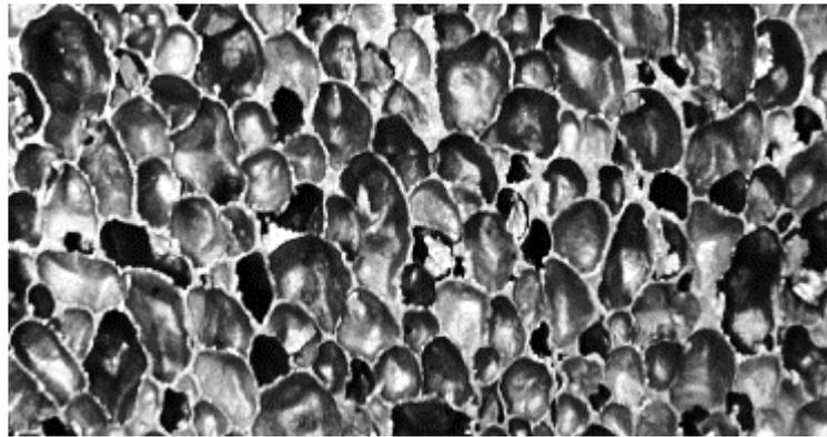
**Figura 7:** micrografía de espuma de aluminio de poro cerrado [13].
