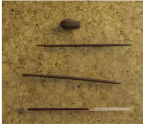
Figura 4: Cilindros para determinar el índice plástico
