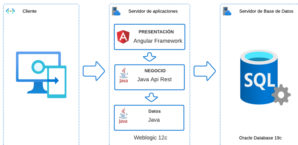
Fig. 26. Arquitectura del Generador de Código Fuente
