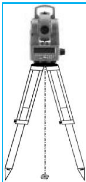
Imagen 11. Nivelación de la Estación Total
