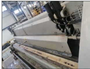
Figura 21. Cubierta metálica protectora del motor
