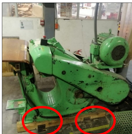
Figura 18. Sujeción actual de la máquina BMD
