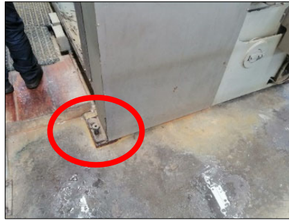
Figura 23. Sujeción actual de la máquina descarnadora
