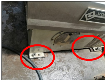
Figura 23. Sujeción actual de la máquina descarnadora
