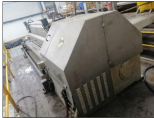
Figura 21. Cubierta metálica protectora del motor
