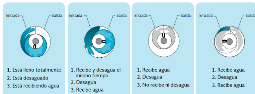
Figura 3. Funcionamiento de medidor volumétrico
