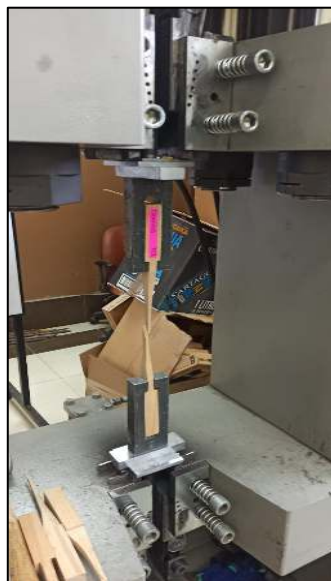
Figura 49. Falla a tracción
