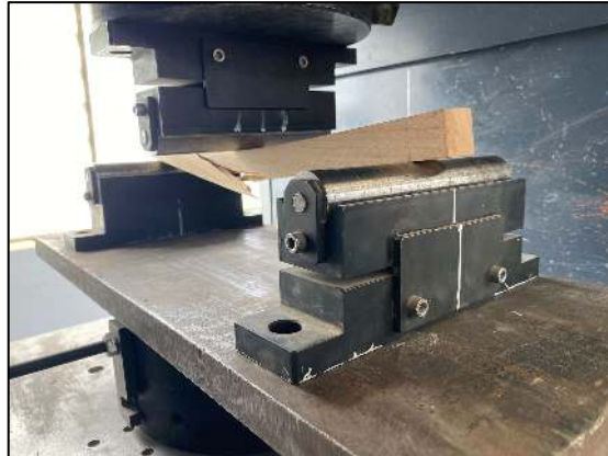
Figura 46. Falla generada en la probeta
