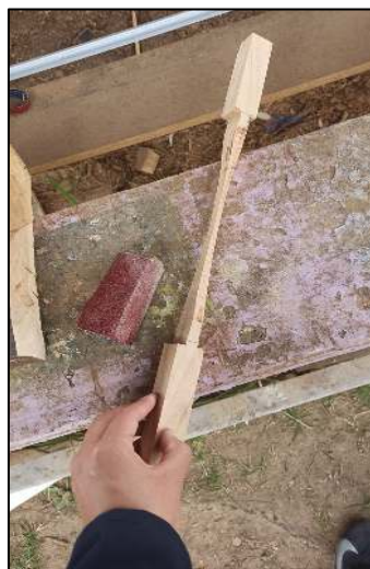
Figura 41 . Pulido de probeta
