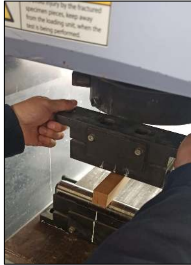
Figura 44. Aplicación del bloque de carga
