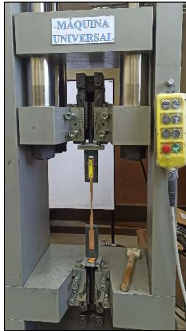
Figura 48. Colocación de probetas
