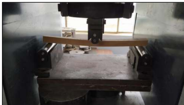
Figura 24. Ensayo de resistencia a la flexión de la madera
