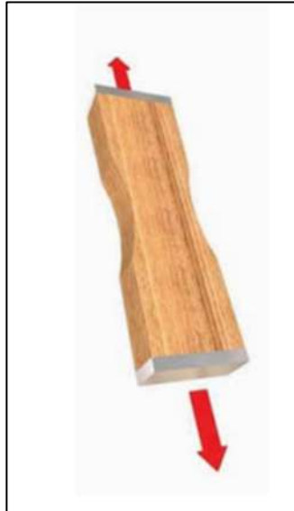
Figura 9. Esquema de ensayo a tracción paralela a las fibras.
