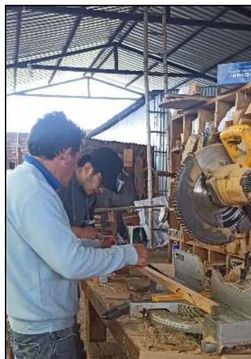
Figura 36. Corte de probetas
