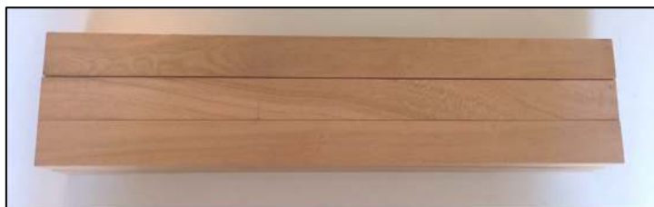
Figura 31. Probetas a flexión
