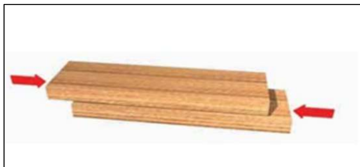
Figura 10. Esquema de ensayo de cizallamiento longitudinal.
