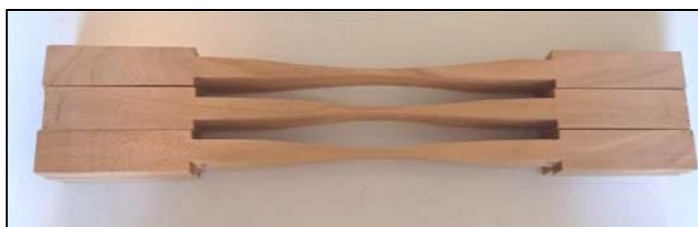
Figura 32. Probetas a tracción
