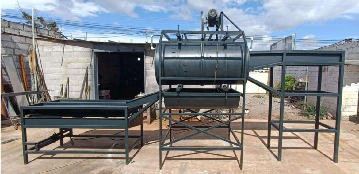
**Figura 60.**Máquina lavadora y clasificadora diseño real
