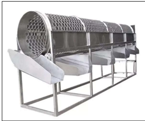
**Figura 11.**Cilindro Rotatorio [35].
