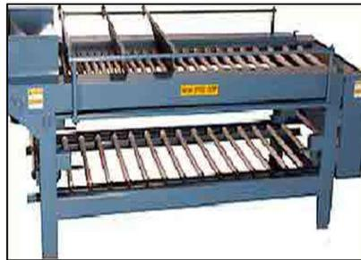
**Figura 13.**Clasificadora de rodillos con bandas transportadoras. [37]
