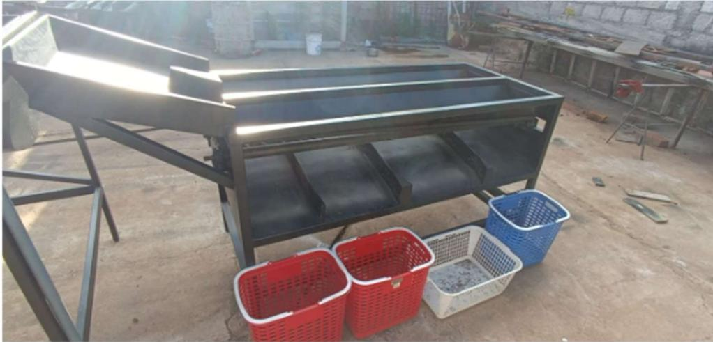
**Figura 62.**Máquina lavadora de papas en funcionamiento
