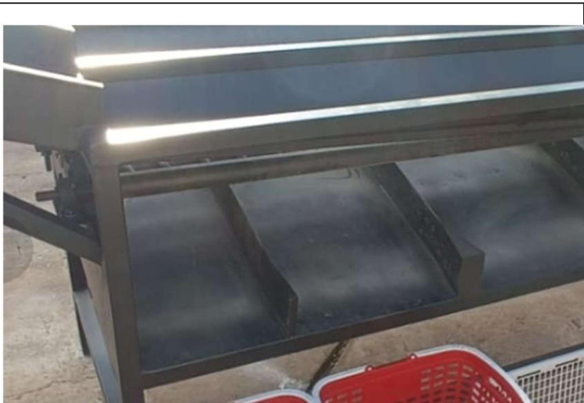
Está diseñada para realizar la separación de las papas según el diámetro de estas.
