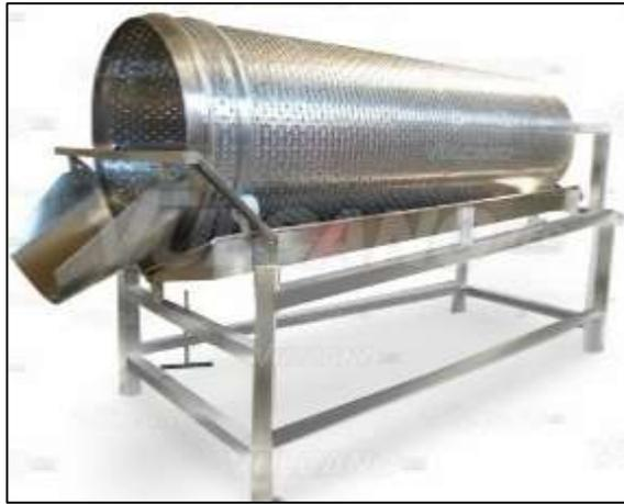
**Figura 7.**Lavadora con tanque giratorio [32].
