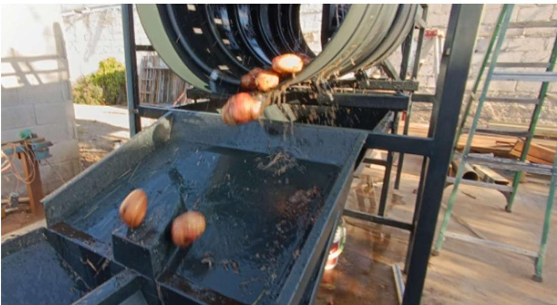
**Figura 61.**Máquina lavadora de papas en funcionamiento
