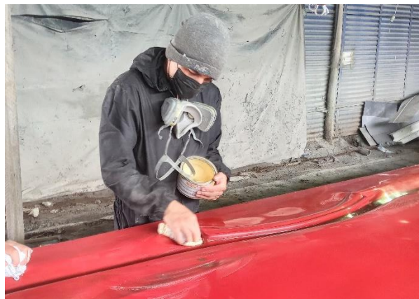
Figura 13 Aplicación de capas de cera
