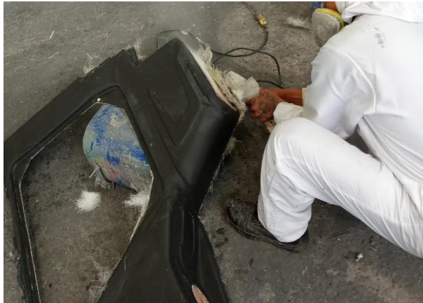
Figura 20 Corte de Excesos
