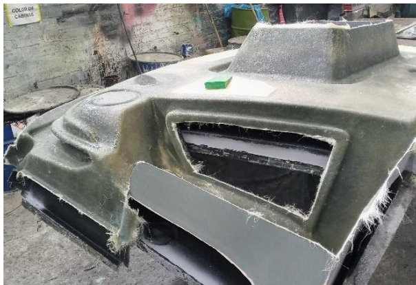
Figura 21 Desmoldado de la pieza
