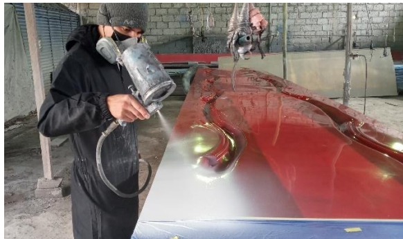
Figura 15 Aplicación de Gel Coat
