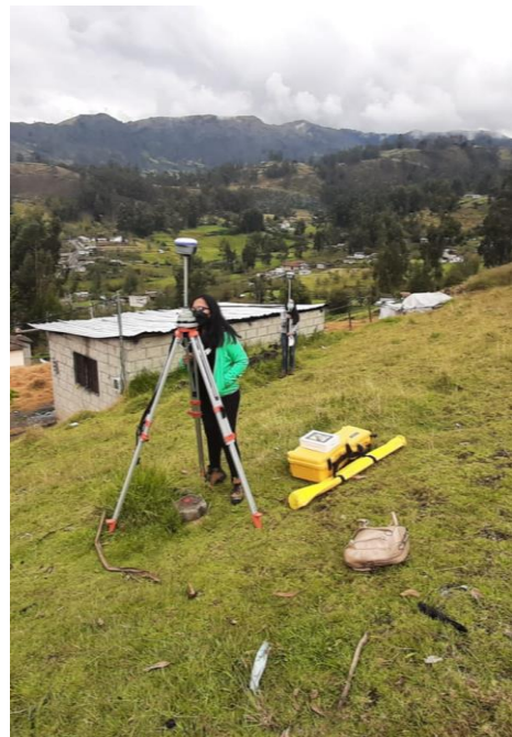
Nivelación del equipo topográfico (RTK Chenav i90).
