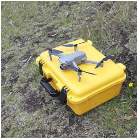
Equipo para levantamiento topográfico: Dron Mavic Air 2s.
