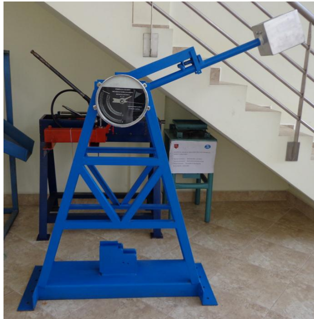
Figura 6-38 Máquina Charpy. (Fuente: El autor)
