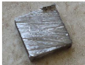
Figura 3-1 Toma de muestra del acero 8620
