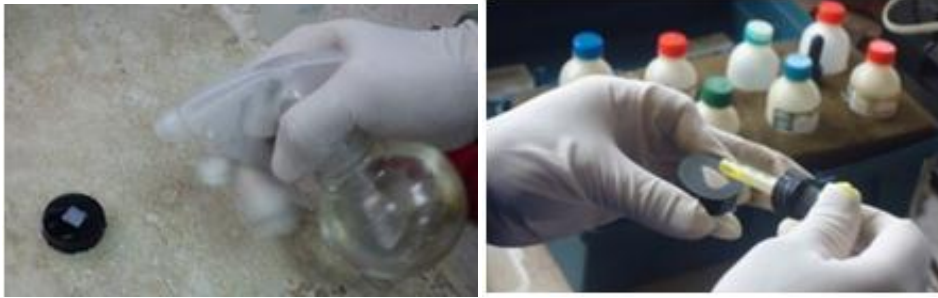
Figura 3-9 Ataque Químico con Nital 4
