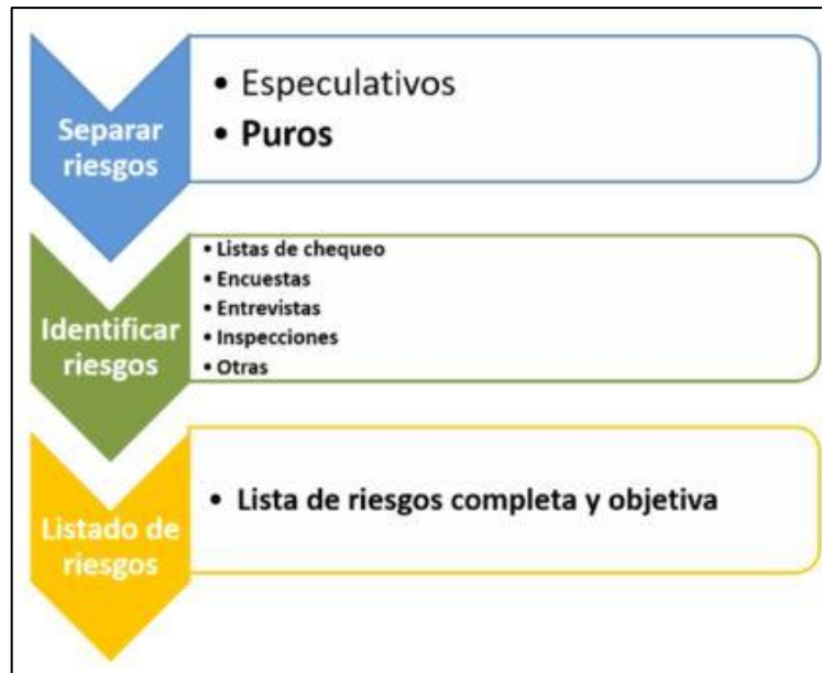
Fig. 8. Etapas de la identificación del riesgo [18].
