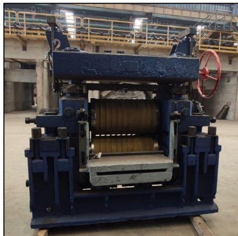
Figura 15. Caseta Pomini del tren de producción 1.
