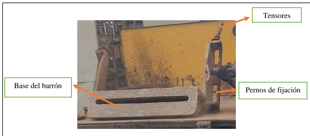
Figura 12. Partes del barrón estático.
