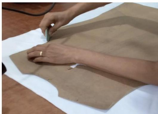
**Figura 12:** Proceso de trazado sobre tela.
