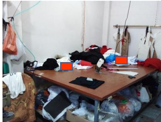
**Figura 32:** Tarjeta roja en el proceso de trazado y corte.
