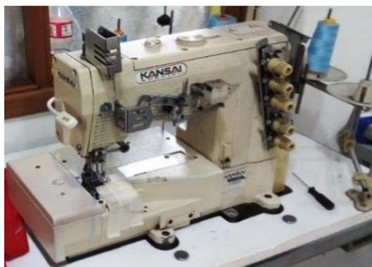
**Figura 18:** Máquina recubridora.
