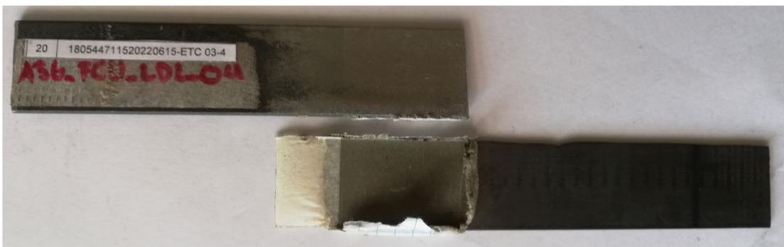
**Figura 3.20** a) Gráfica Fuerza vs Desplazamiento, b) Gráfica Esfuerzo vs Alargamiento, c) Tipo de Falla Adhesiva de la probeta A36-FCU-LDL-04
