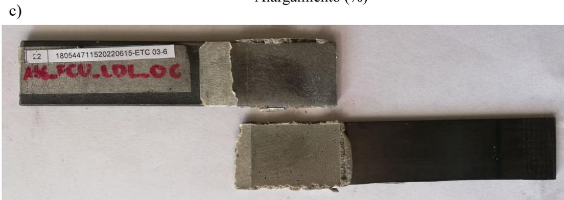
**Figura 3.22** a) Gráfica Fuerza vs Desplazamiento, b) Gráfica Esfuerzo vs Alargamiento, c) Tipo de Falla Adhesiva de la probeta A36-FCU-LDL-06
