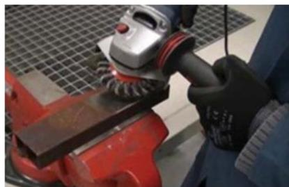
**Figura 1.20** Limpieza por máquina herramienta [42], [43].
