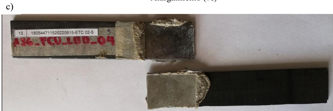
**Figura 3.13** a) Gráfica Fuerza vs Desplazamiento, b) Gráfica Esfuerzo vs Alargamiento, c) Tipo de Falla Adhesiva de la probeta A36-FCU-LDD-05
