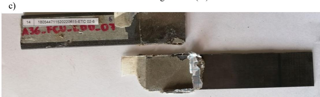
**Figura 3.14** a) Gráfica Fuerza vs Desplazamiento, b) Gráfica Esfuerzo vs Alargamiento, c) Tipo de Falla Adhesiva de la probeta A36-FCU-LDD-06
