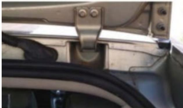
**Figura 1.13** Unión mixta (soldadura y adhesivo) [37]
