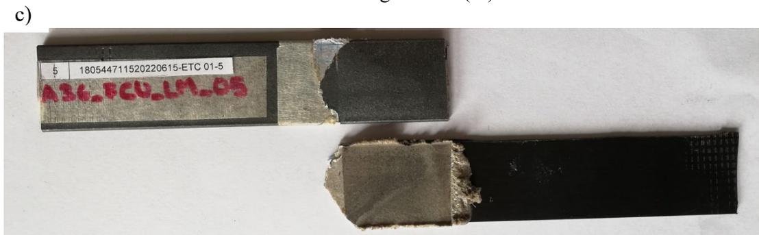
**Figura 3.5** a) Gráfica Fuerza vs Desplazamiento, b) Gráfica Esfuerzo vs Alargamiento, c) Tipo de falla Adhesiva de la probeta A36-FCU-LM-05
