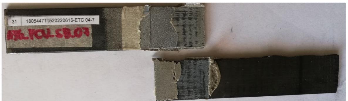
**Figura 3.31** a) Gráfica Fuerza vs Desplazamiento, b) Gráfica Esfuerzo vs Alargamiento, c) Tipo de Falla Adhesiva/Cohe­sivo de la probeta A36-FCU-SB-07
