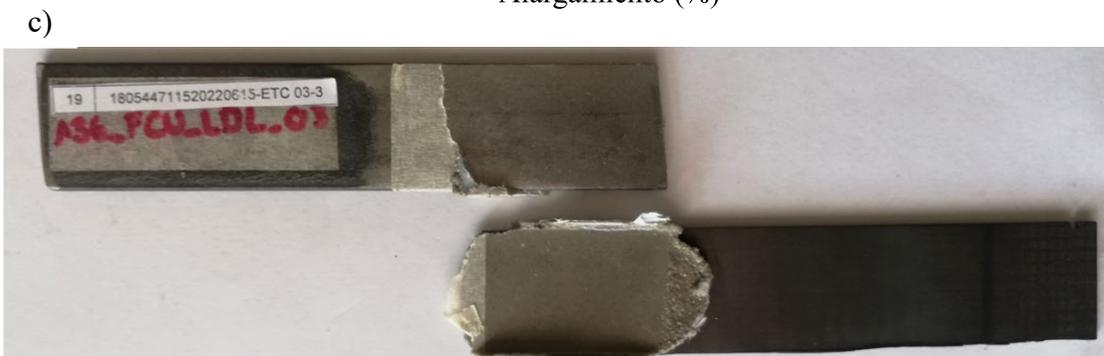
**Figura 3.19** a) Gráfica Fuerza vs Desplazamiento, b) Gráfica Esfuerzo vs Alargamiento, c) Tipo de Falla Adhesiva de la probeta A36-FCU-LDL-03
