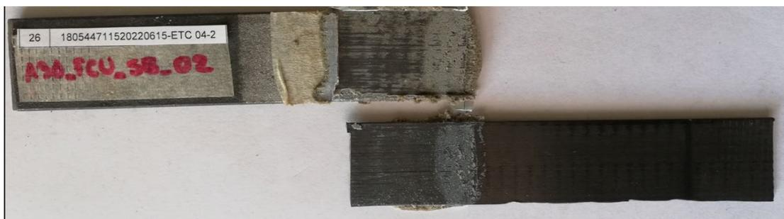
**Figura 3.26** a) Gráfica Fuerza vs Desplazamiento, b) Gráfica Esfuerzo vs Alargamiento, c) Tipo de Falla Adhesiva de la probeta A36-FCU-SB-02
