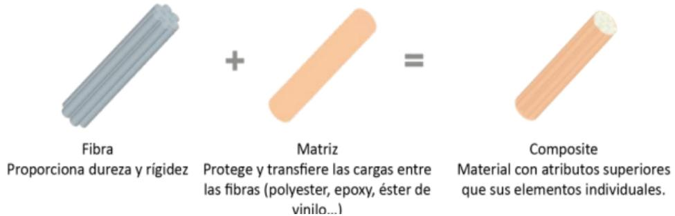
**Figura 1.5** Esquema de los materiales compuestos [25].
