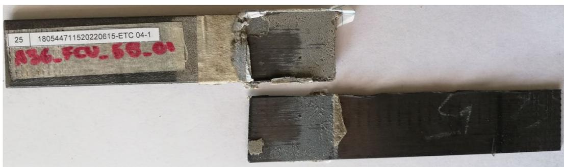
**Figura 3.25** a) Gráfica Fuerza vs Desplazamiento, b) Gráfica Esfuerzo vs Alargamiento, c) Tipo de Falla Adhesiva de la probeta A36-FCU-SB-01
