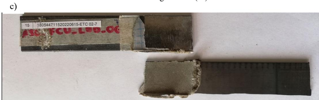
**Figura 3.15** a) Gráfica Fuerza vs Desplazamiento, b) Gráfica Esfuerzo vs Alargamiento, c) Tipo de Falla Adhesiva de la probeta A36-FCU-LDD-07
