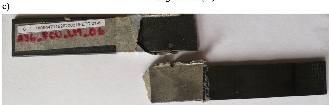
**Figura 3.6** a) Gráfica Fuerza vs Desplazamiento, b) Gráfica Esfuerzo vs Alargamiento, c) Tipo de falla Adhesiva de la probeta A36-FCU-LM-06
