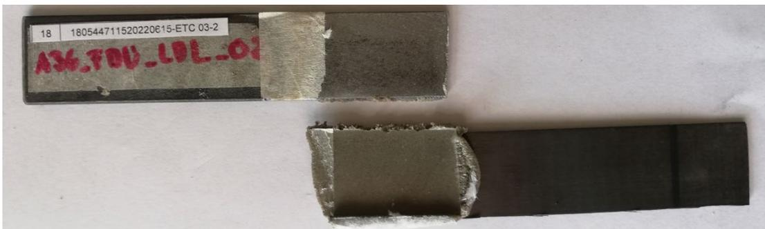
**Figura 3.18** a) Gráfica Fuerza vs Desplazamiento, b) Gráfica Esfuerzo vs Alargamiento, c) Tipo de Falla Adhesiva de la probeta A36-FCU-LDL-02
