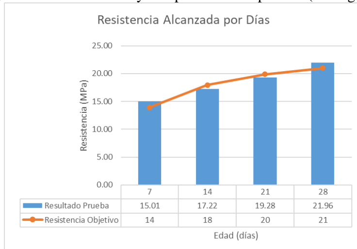
Figura 8. Resultado ensayo de prueba a compresión (210 kg/cm 2 )
