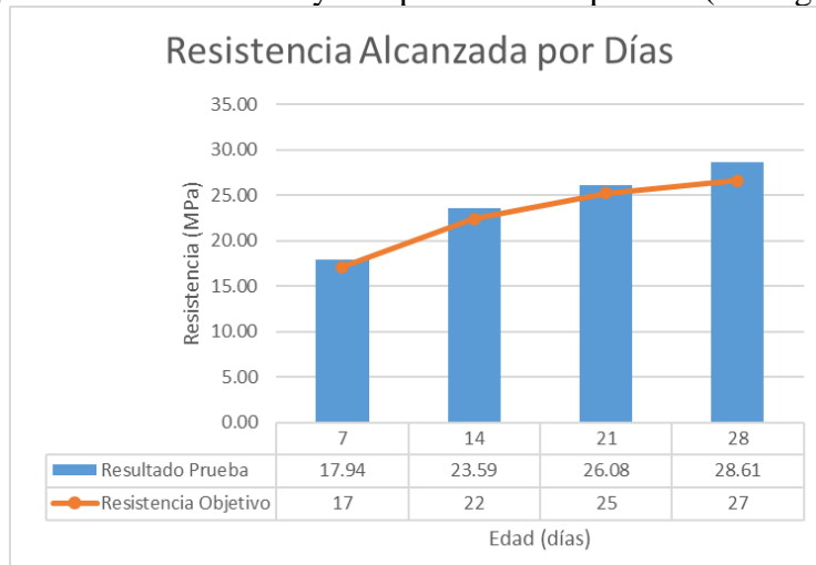
Figura 9. Resultado ensayo de prueba a compresión (280 kg/cm 2 )
