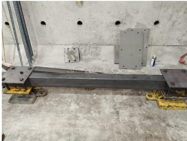
Imagen N° 6. Ubicación de columna 150x100x3mm.
