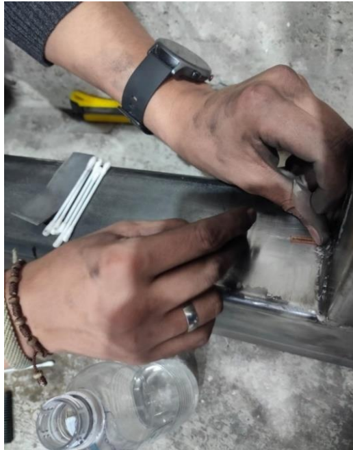
Imagen N° 11. Colocación de Strain Gauges.
