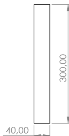
Figura 20 Dimensiones de aberturas de salidas de aire en mm
