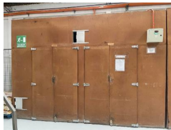
Figura 19 Secador estático de bandejas para fideo tipo cabello
