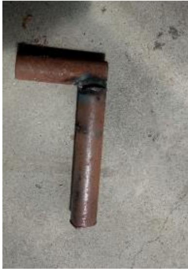
*Figura 73. Soldadura en el eje tipo "L" para la sujeción de los Motores CIROLLA 5006*
