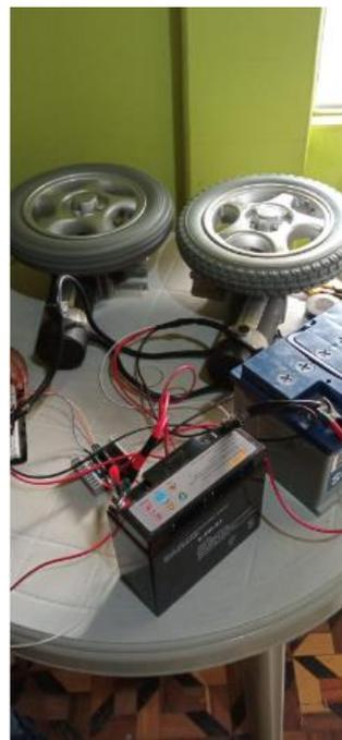
*Figura 66. Ajuste de alimentación de Motor DC CIROLLA 5006*
