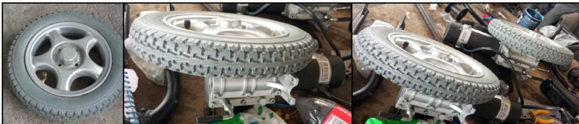
*Figura 55. Integración de ruedas a los Motores DC*
