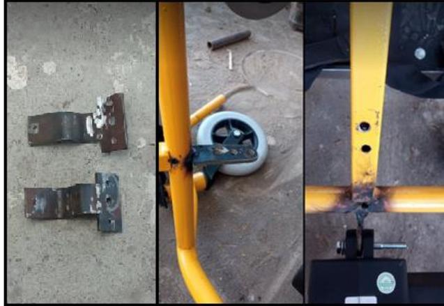
Figura 50. Soldadura en el eje intermedio para la incorporación del actuador lineal,
