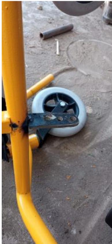
*Figura 72. Soldadura en el eje intermedio inferior para la inclusión del actuador lineal*
