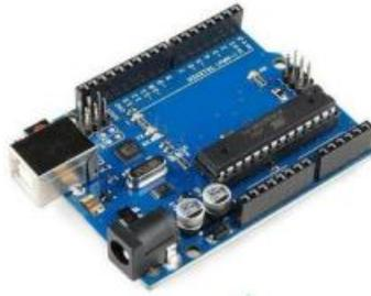
Figura 22. Placa Arduino uno. [48]
