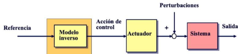
Figura 13. Sistema de control en lazo abierto. [29]
