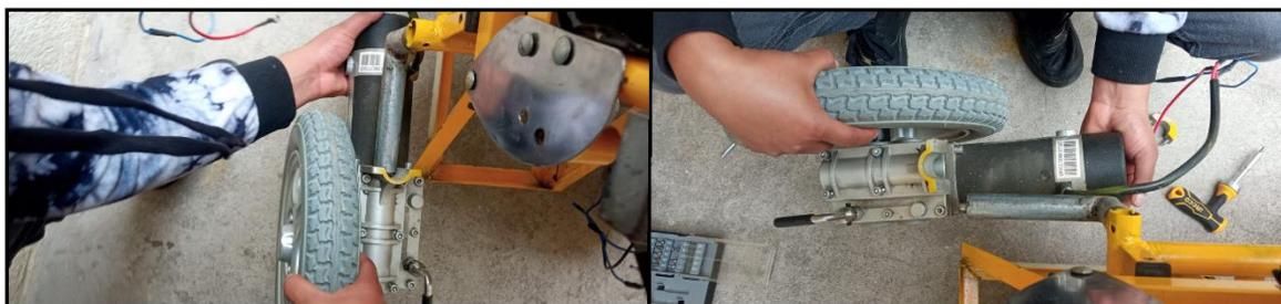
*Figura 56. Integración de los motores en la silla bipedestadora*
