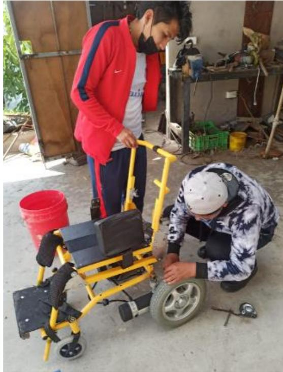
*Figura 69. Extracción de cojines de la silla bipedestadora*
