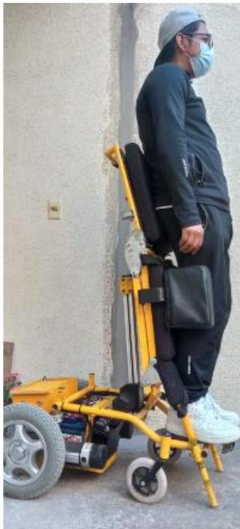
*Figura 83. Conversión de una silla de ruedas a un bipedestador*
