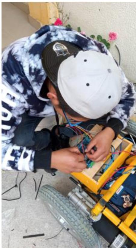
*Figura 79. Adecuación de cableado el prototipo de control del sistema en una caja de protección*
