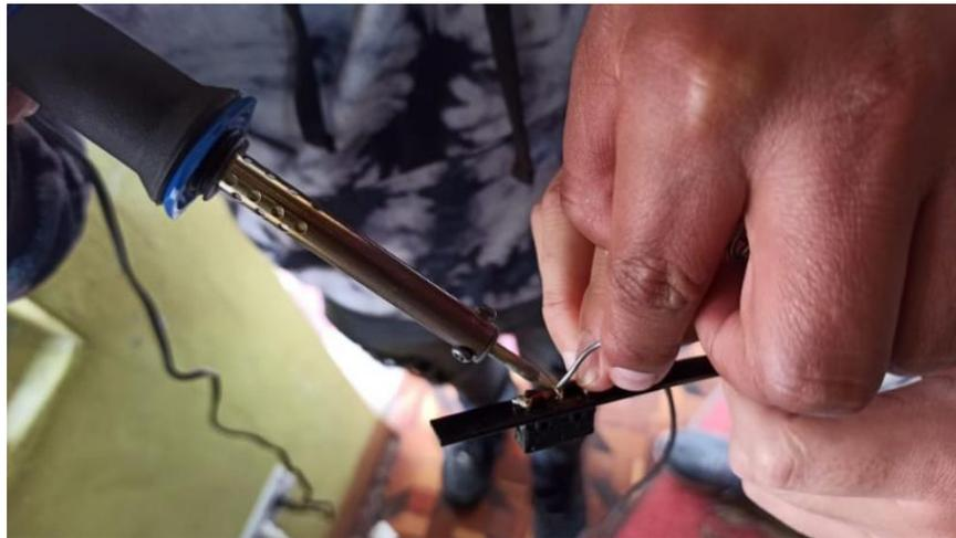
*Figura 76. Soldadura de los finales de carrera para la inclusión en el actuador lineal*
