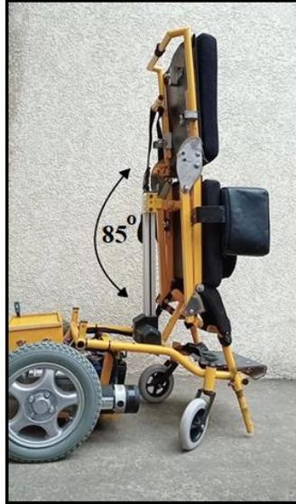
*Figura 53. Ángulo máximo de inclinación*
