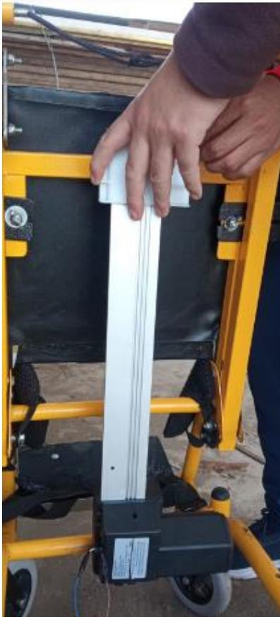
*Figura 75. Inclusión del actuador lineal FY014*
