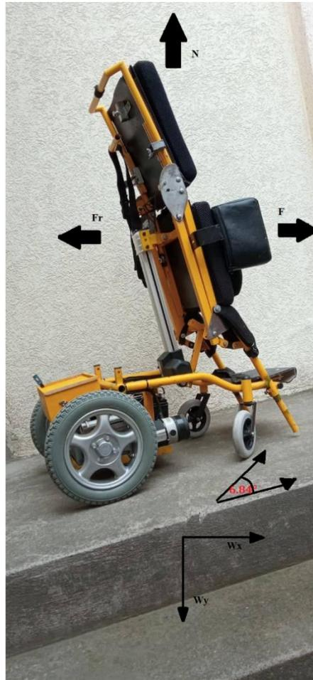
Figura 34. Dimensionamiento de potencia del motor en una superficie inclinada
