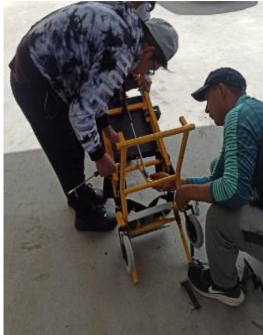
*Figura 68. Extracción del cilindro hidráulico*
