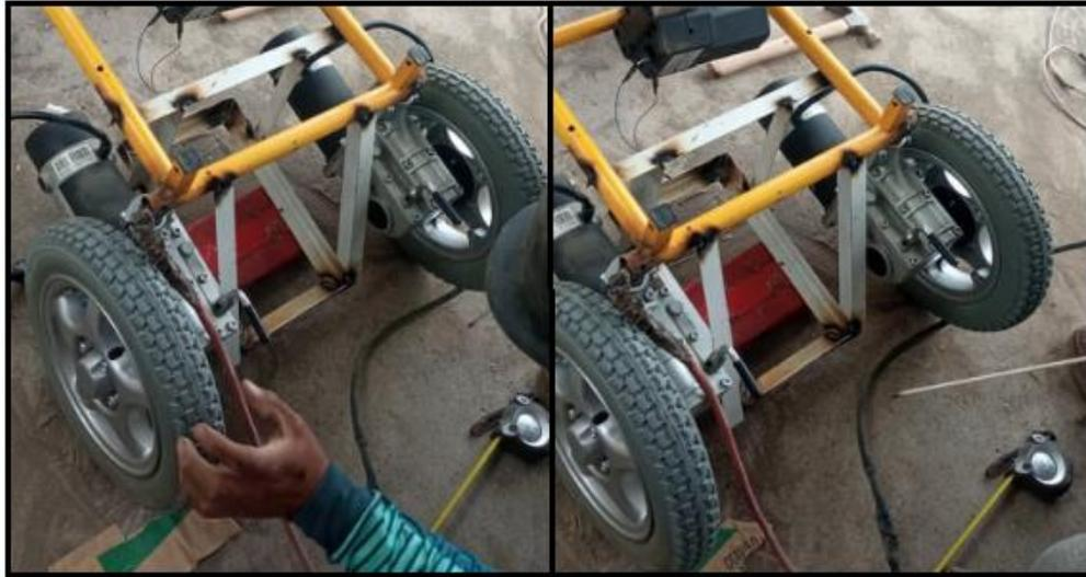
*Figura 52. Ejes para sujeción de las baterías*
