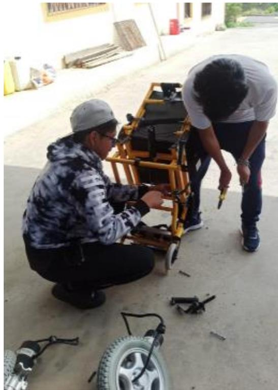
*Figura 70. Extracción de ejes auxiliares de la silla bipedestadora*
