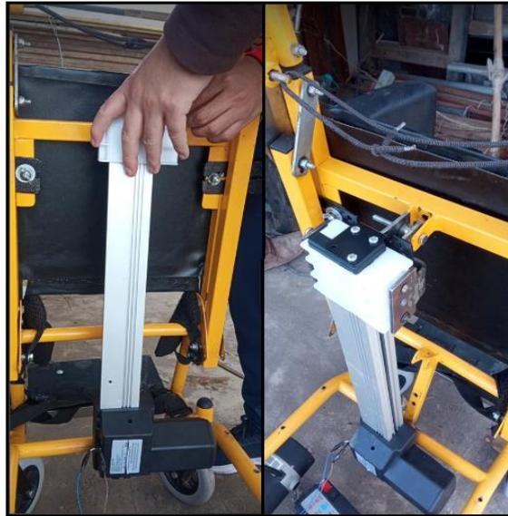
*Figura 57. Incorporación del actuador lineal*
