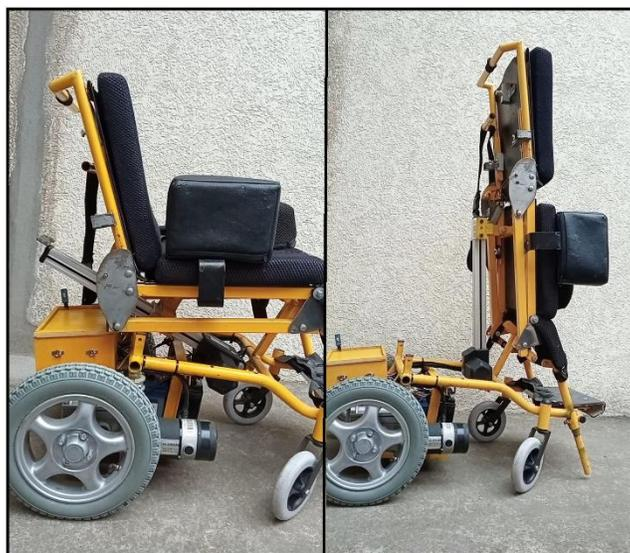
Figura 63. Proceso de extracción, retracción de la silla de ruedas a un bipedestador
