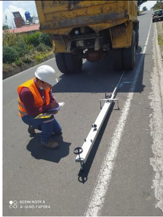
Descripción: Medición de las deflexiones a con la Viga Benkelman.
