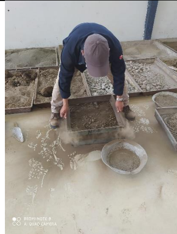
Descripción: Tamizando a través del tamiz \frac{3}{4} .
