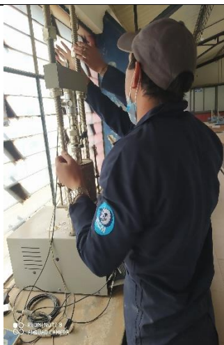
Descripción: Colocando la muestra en la máquina de compresión.
