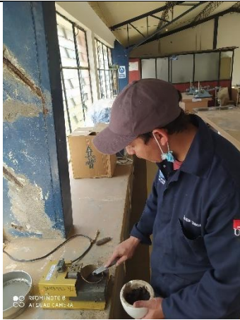
Descripción: Determinación del límite líquido con la copa de casa grande.
