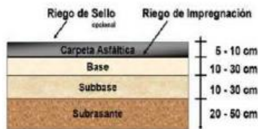
Figura 5. Estructura de un pavimento flexible
