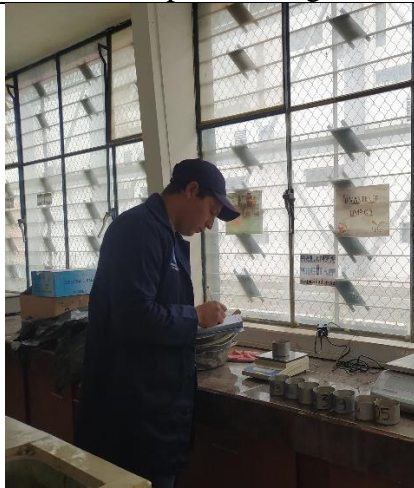
Descripción: Pesando los recipientes para la toma de muestras.
