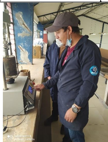
Descripción: Configurando la máquina para el ensayo de CBR.
