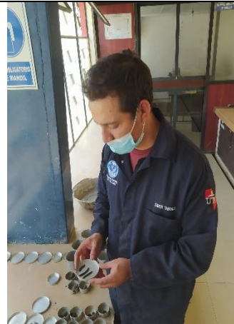
Descripción: Determinando el límite plástico.
