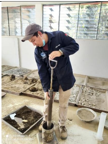
Descripción: Compactación de la muestra con una humedad óptima.
