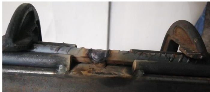
Figura 17: SMAW junta a tope con bisel en V simple - pase #5.
