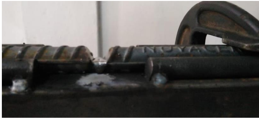
Figura 39: FCAW junta a tope con bise en V simple – pase #1.
