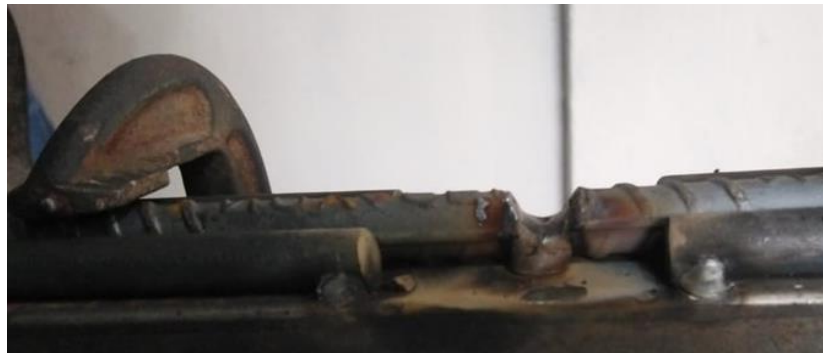
Figura 26: GMAW junta a tope con bisel en V simple – pase #1 y #2.
