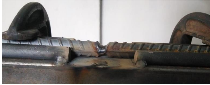
Figura 20: SMAW junta a tope con bisel en V doble - pase #1.
