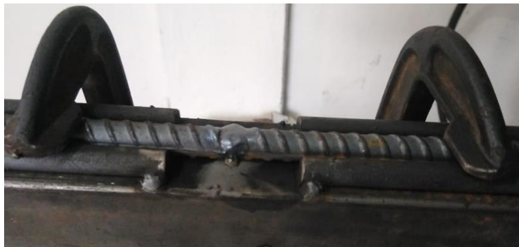
Figura 47: FCAW junta a tope con bise en V doble – pase #3.
