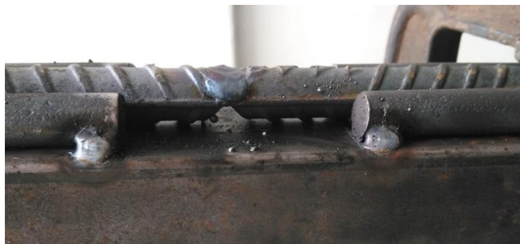
Figura 34: GMAW junta a tope con bise en V doble – pase #3.
