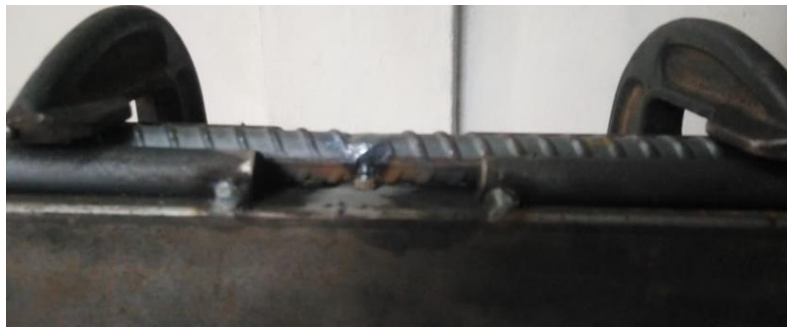
Figura 46: FCAW junta a tope con bise en V doble – pase #2.
