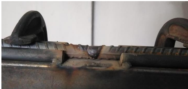
Figura 22: SMAW junta a tope con bisel en V doble - pase #4 y #5.
