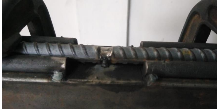
Figura 45: FCAW junta a tope con bise en V doble – pase #1.
