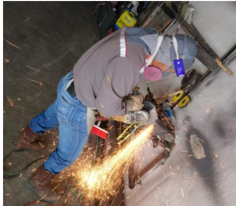
Figura 8: Corte y biselado de las probetas.
