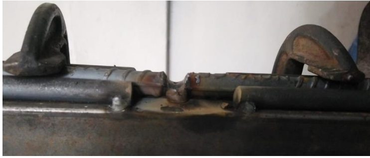
Figura 14: SMAW junta a tope con bisel en V simple - pase #2.
