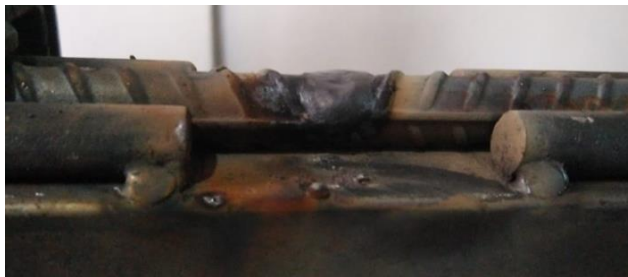
Figura 23: SMAW junta a tope con bisel en V doble – pase #6.
