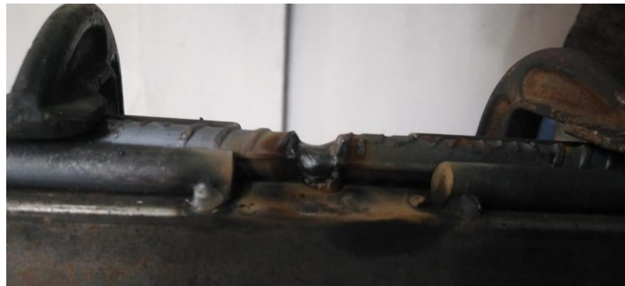
Figura 15: SMAW junta a tope con bisel en V simple- pase #3.
