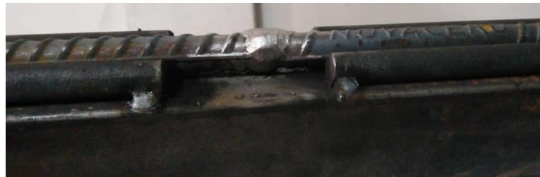
Figura 43: Figura 39: FCAW junta a tope con bise en V simple – pase final.
