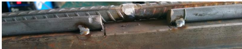
Figura 30: GMAW junta a tope con bisel en V simple – pase #7 y resanado.
