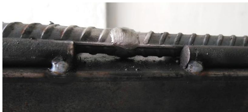
Figura 37: GMAW junta a tope con bise en V doble – pase #7 y #8.
