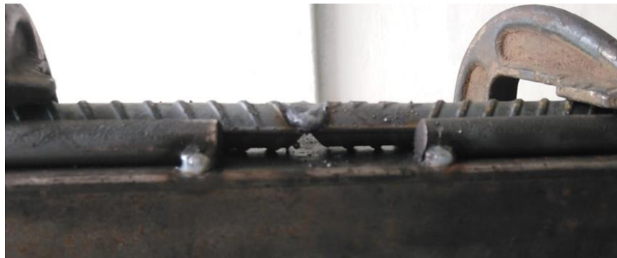
Figura 33: GMAW junta a tope con bise en V doble – pase #1 y #2.
