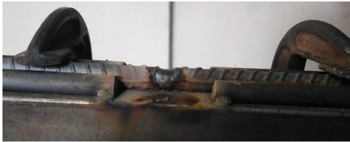
Figura 21: SMAW junta a tope con bisel en V doble - pase #2 y #3.
