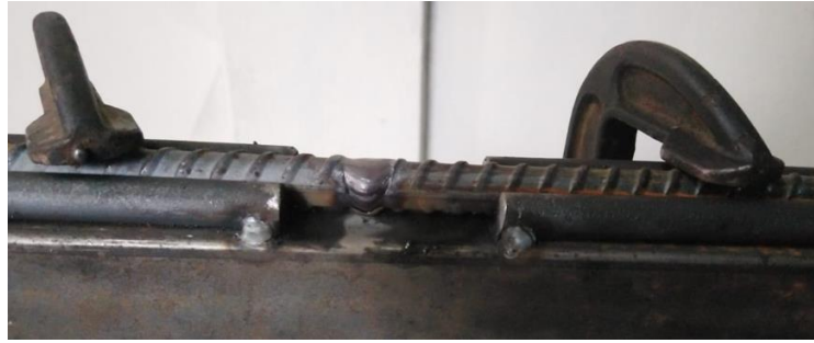
Figura 28: GMAW junta a tope con bisel en V simple – pase #5.
