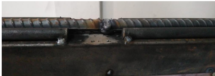
Figura 42: FCAW junta a tope con bise en V simple – pase resanado.
