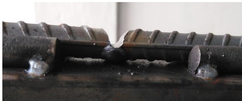
Figura 36: GMAW junta a tope con bise en V doble – resanado.
