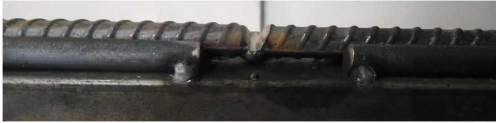
Figura 48: FCAW junta a tope con bise en V doble – resanado.
