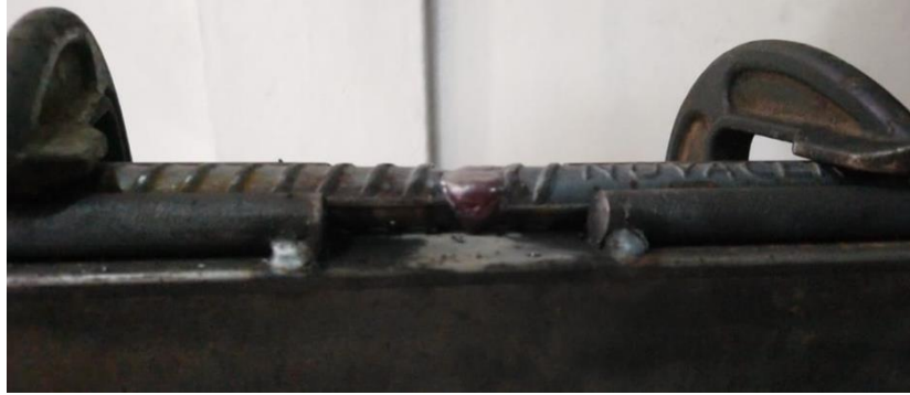
Figura 41: FCAW junta a tope con bise en V simple – pase #3.
