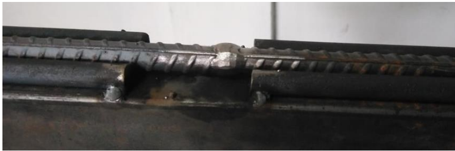
Figura 49: FCAW junta a tope con bise en V doble – pase final.
