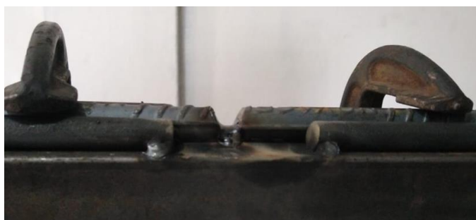
Figura 13: SMAW junta a tope con bisel en V simple - pase #1.
