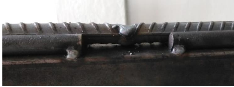
Figura 35: GMAW junta a tope con bise en V doble – pase #4.
