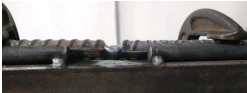
Figura 40: FCAW junta a tope con bise en V simple – pase #2.
