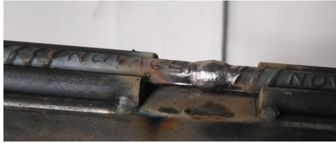
Figura 18: SMAW junta a tope con bisel en V simple – pase 6 y resanado.
