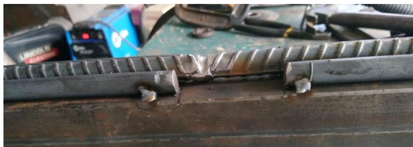
Figura 29: GMAW junta a tope con bisel en V simple – pase #6.
