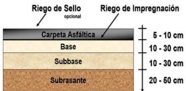
Gráfico 1. Estructura de Pavimento Flexible
