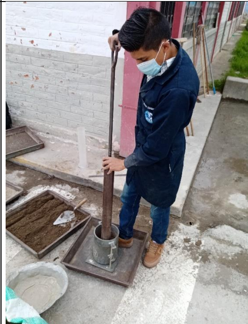
Fotografía 4 Ensayo de Compactación
