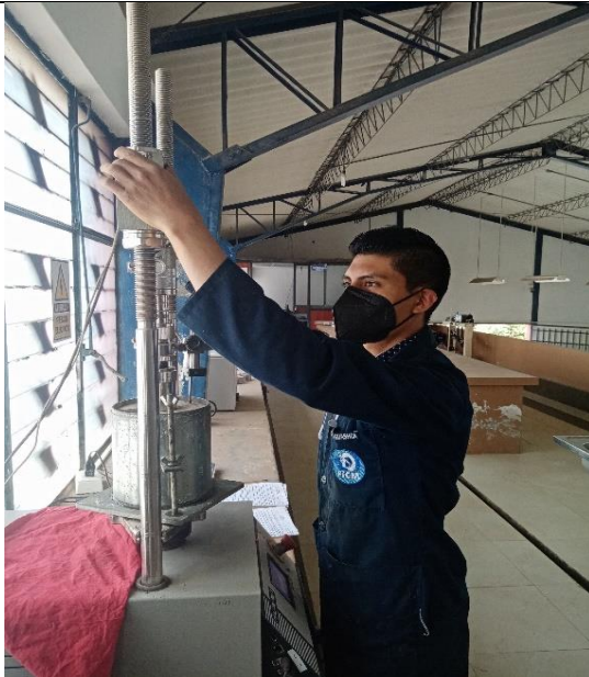
Fotografía 5 Ensayo de Carga - Penetración
