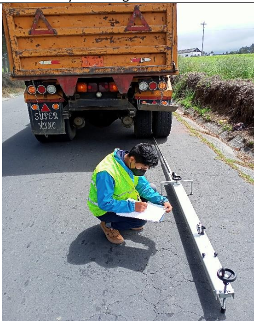
Fotografía 7 Medición de deflexiones con la viga Benkelman
