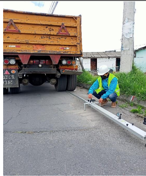
Fotografía 6 Armado de la Viga Benkelman
