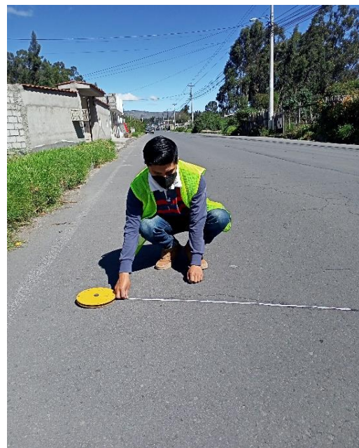
Fotografía 8 Evaluación de Pavimento por el método de (PCI)
