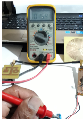
FIGURA 59: Salida de voltaje directa empleando la antena HRPSA. Elaborado por: Investigador
