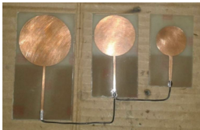
FIGURA 5: Antenas con geometría circular implementada en serie [7].
