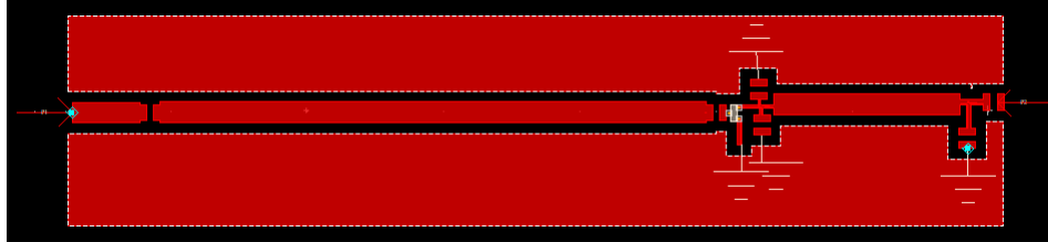
FIGURA 55: Geometría circuito rectificador implementado en ADS software. Elaborado por: Investigador.
