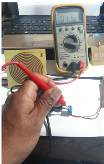
FIGURA 60: Salida de voltaje directa empleando la antena ASMA. Elaborado por: Investigador.
