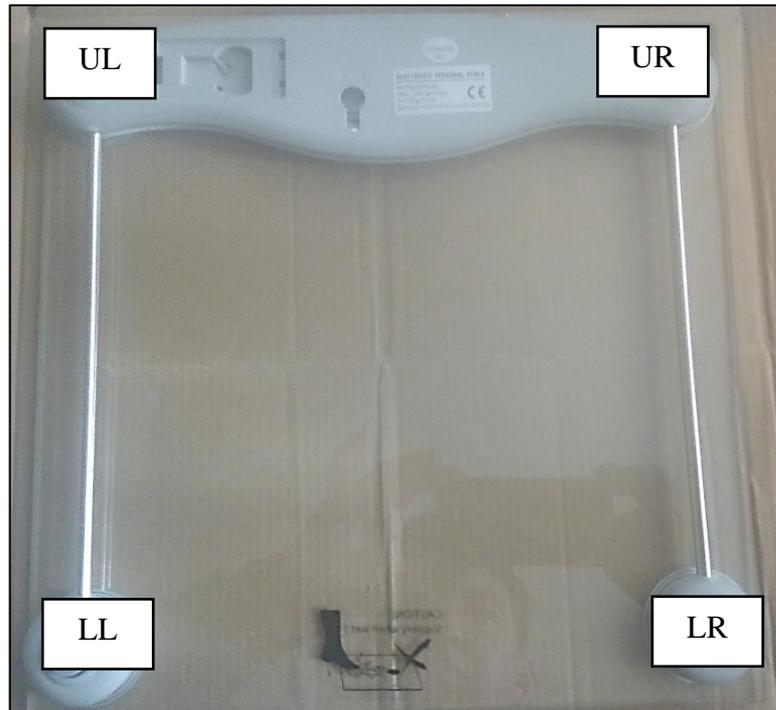
**Figura 18:** Denominación de los cuatro sensores de carga.
