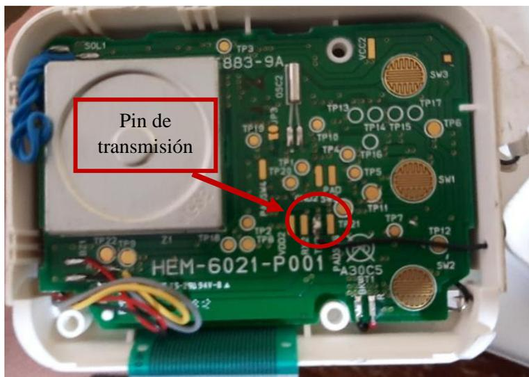
**Figura 28:** Tensiómetro desarmado marca OMRON HEM-631
