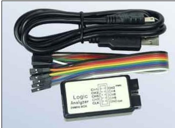
**Figura 6:** Analizador Lógico de 8 canales [38].
