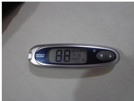
**Figura 109:** Medición del nivel de glucosa mediante el glucómetro digital
