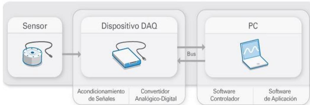
**Figura 3:** Partes de un sistema de Adquisición de Datos [32].
