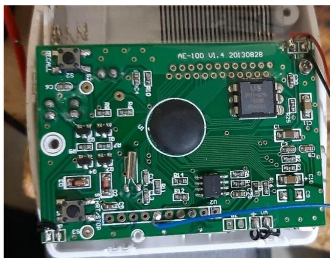
**Figura 29:** Tensiómetro desarmado CK-101
