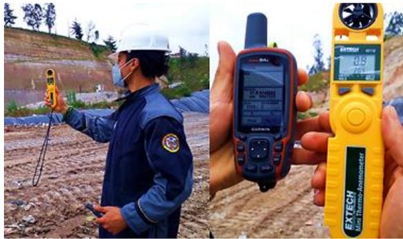
**Figura 23.** Medición de temperatura, altura y velocidad del viento en el relleno sanitario de Ambato
