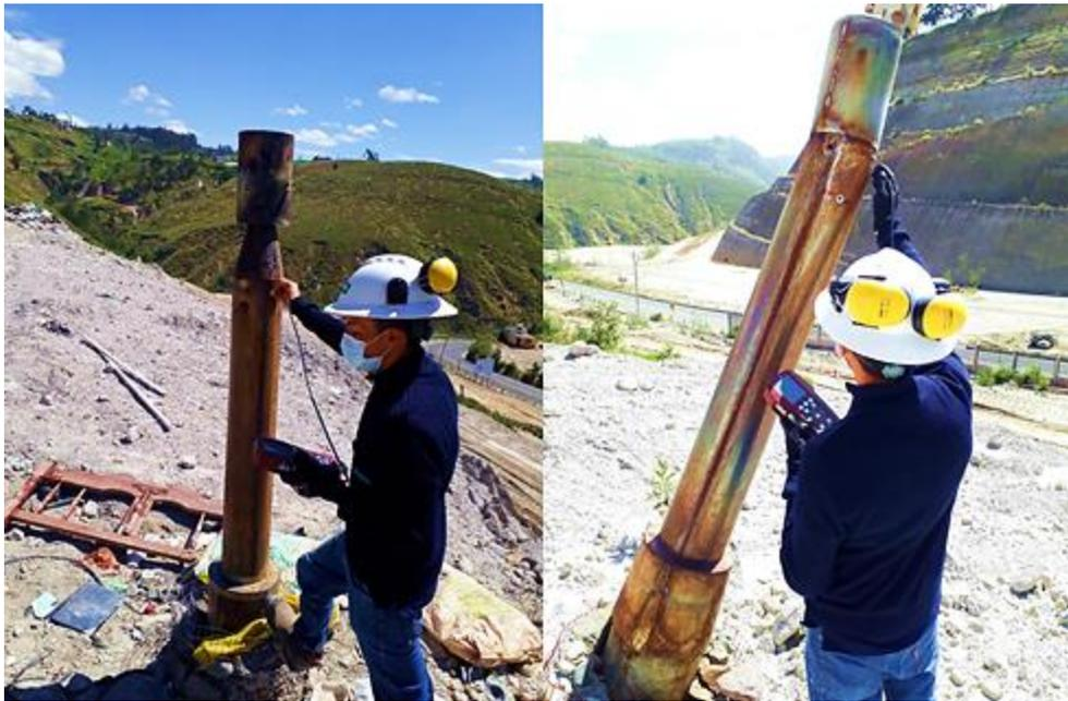
**Figura 30.** Medición del biogás producido en el relleno sanitario de Ambato
