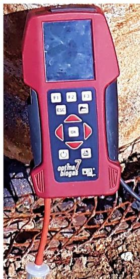
**Figura 14.** Equipo portátil para medición de gases ÓPTIMA7 Biogás
