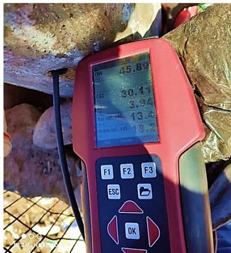
**Figura 31.** Lectura de los compuestos del biogás con un alto contenido de metano
