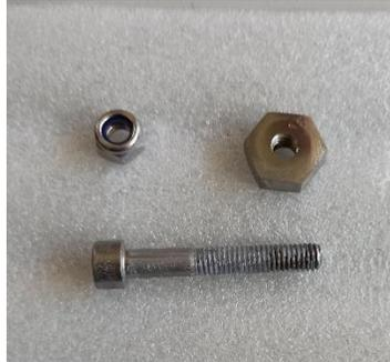
1. Insertar la tuerca comercial en el cuerpo hasta que quede completamente dentro
