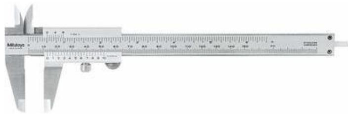
*Figura 26. Calibrador pie de rey [55].*
