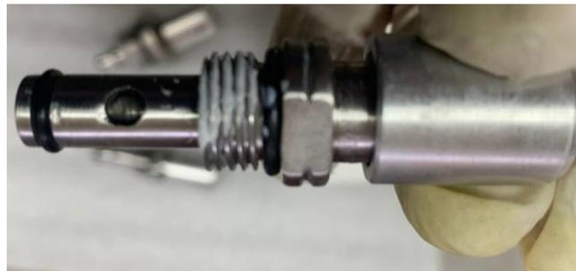
7. Inserte el GIN 1761 en el ensamble anterior y el BIC 0059 con la herramienta hexagonal, el torque aplicado es de 1 Nm
