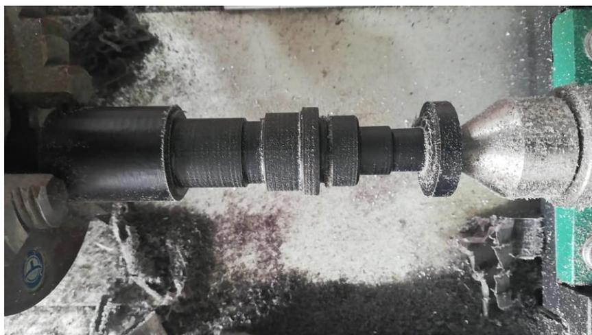
*Figura 176. Mecanizado de elemento.*
