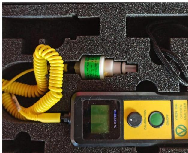
*Figura 172. Medidor de oxígeno.*
