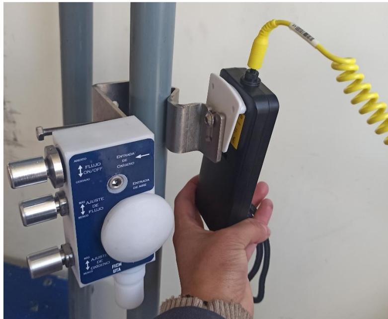
**Figura 7.** Montaje de analizador de oxígeno
