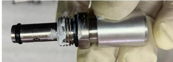
7. Inserte el GIN 1761 en el ensamble anterior y el BIC 0059 con la herramienta hexagonal, el torque aplicado es de 1 Nm
