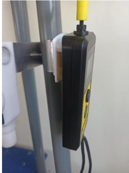
**Figura 8.** Montaje de analizador de oxígeno
