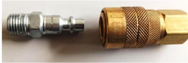
*Figura 51. Acople rápido para aire.*
