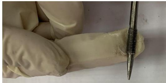
2. Aplicar grasa en el o ring BIC 0066 y colocarlo en la parte que se indica entre la parte GIN 1765 Y GIN 1766 y BIC 0066 tal y como se indica en la figura.
