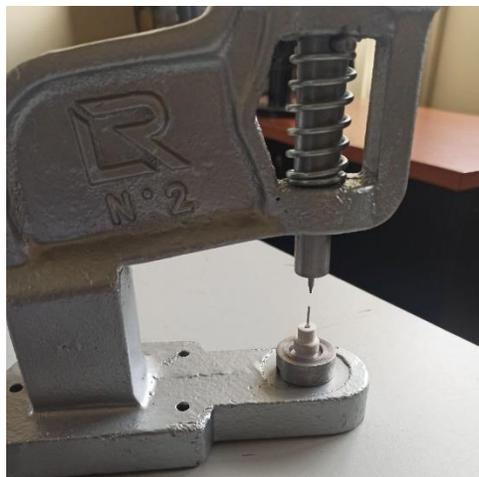
2. Aplicar la presión hasta que el tubo ingrese el elemento y observar hasta observar que llegue a la posición final.
