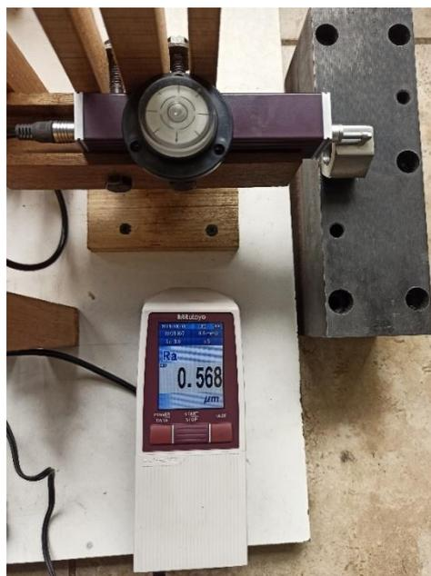
**Figura 184. Medición de rugosidad.**
