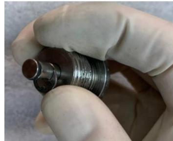
7. Inserte el GIN 1761 en el ensamble anterior y el BIC 0059 con la herramienta hexagonal, el torque aplicado es de 1 Nm
