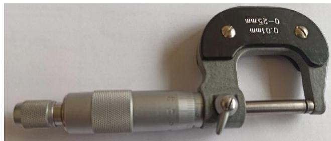
*Figura 27. Micrómetro.*
