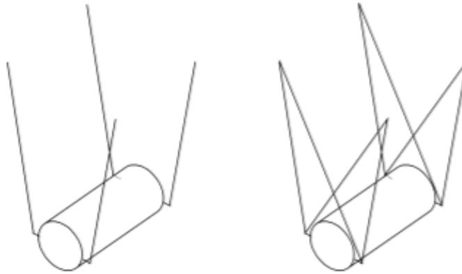
**Figura 1.30:** Suspensión del impactador pendular de 23,4 kg.
