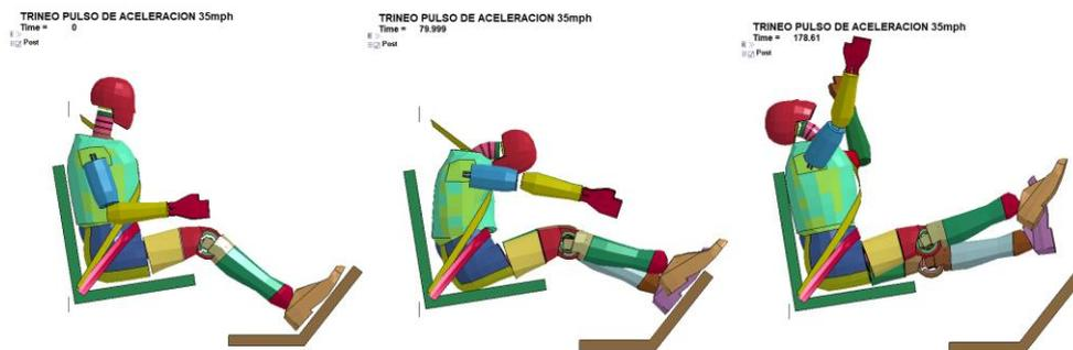
**Figura 3.11:** Secuencia de movimiento del maniquí aplicando pulso de aceleración a 35mph.
