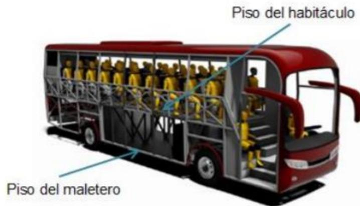
**Figura 1.8:** Armazón del piso del maletero y del habitáculo.
