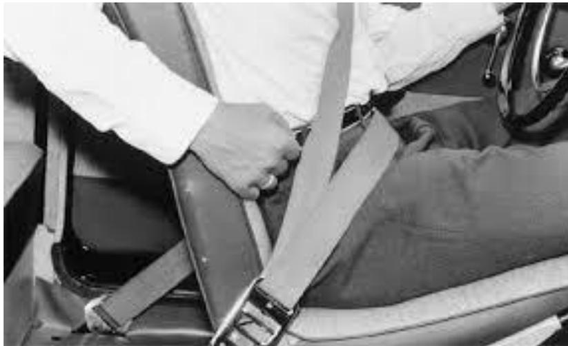
**Figura 1.28:** Cinturón de seguridad.
