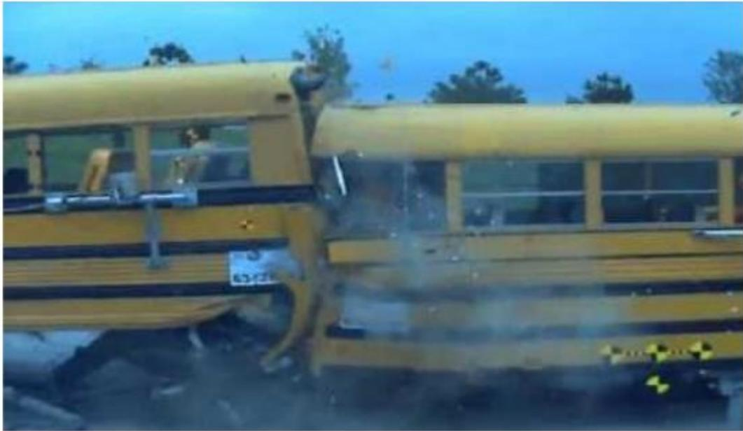
**Figura 1.12:** Ensayo de impacto de una carrocería de bus escolar.
