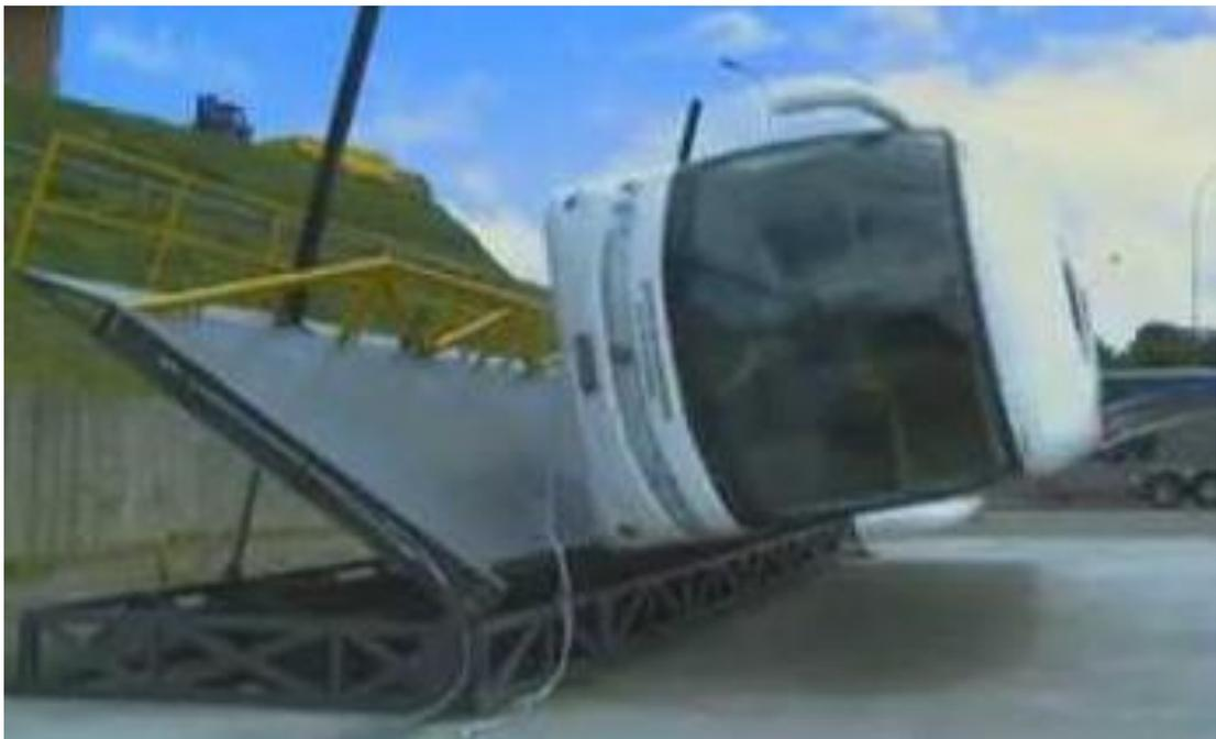
**Figura 1.11:** Prueba antivuelco.
