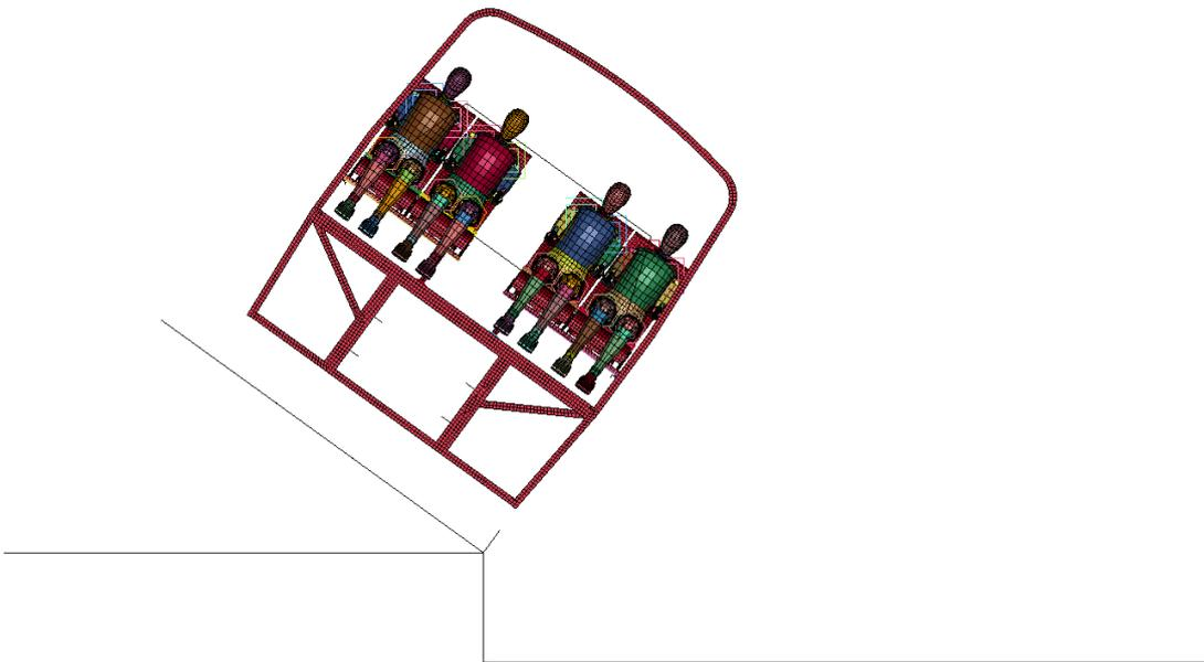
**Figura 3.24:** Ángulo de inestabilidad lateral teórico en la plataforma.
