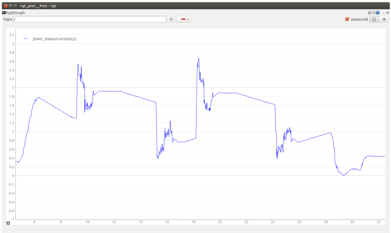
Figura N° 39: Articulación 2, secuencia con 130 gramos
