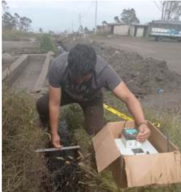
Ilustración 22 Medición de velocidades in-situ
