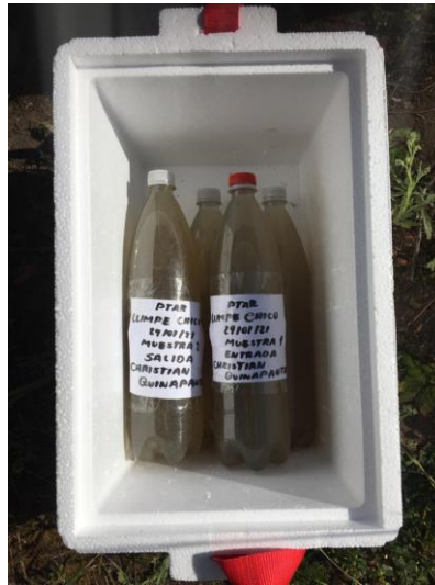
Figura 15: Identificación y conservación de las aguas residuales tomadas de la PTAR. Fuente: Autor.
