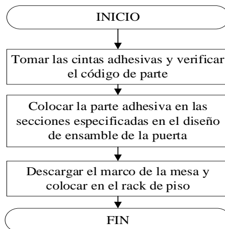
Figura 8: Flujo de actividades - Montaje de parte adhesiva
