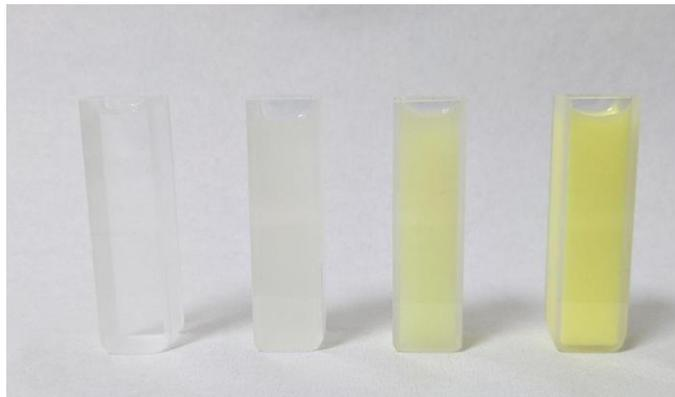
**Figura 27.** Muestras diluidas de la nanoemulsión de curcumina en celdas de cuarzo
