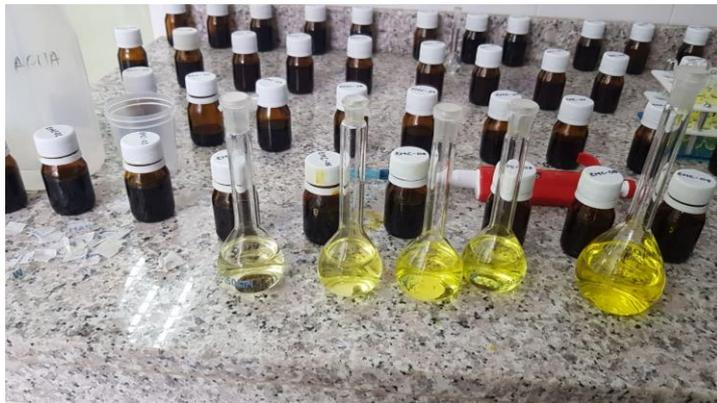
**Figura 24.** Preparación de curva patrón para determinación de curcumina.
