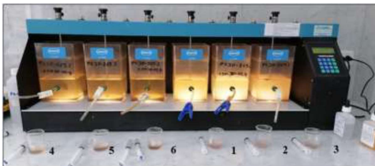
Figura 13. Reacción tras la aplicación del reactivo para identificar sulfuros en las pruebas con oxidante a diferentes concentraciones
