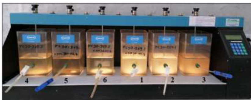
Figura 12. Prueba de jarras (HACH) con la aplicación del oxidante a diferentes concentraciones
