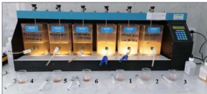
Figura 22. Reacción tras la aplicación del reactivo para identificar sulfuros en las pruebas con coagulante a diferentes concentraciones
