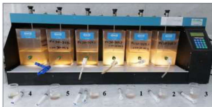
Figura 2. Prueba de jarras (HACH) para la aplicación del oxidante a diferentes concentraciones
