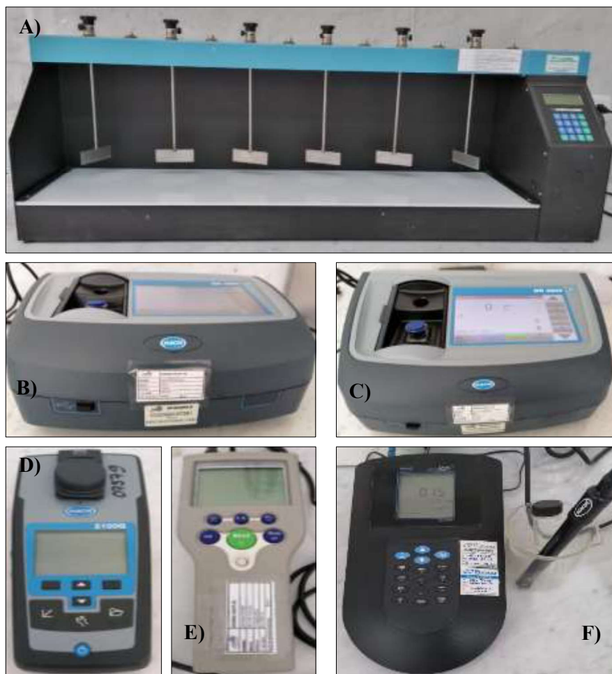
Figura 4. Equipos empleados durante la experimentación. A) Equipo test Jarra (PHIPPS&BIRD) (HACH). B) Espectrofotómetro visible DR3900 (HACH). C) Pantalla del espectrofotómetro visible DR3900 (HACH). D) Turbidímetro 2100Q (HACH). E) pHmetro portátil (METTLER TOLEDO). F) Conductímetro sensation7 (HACH).
