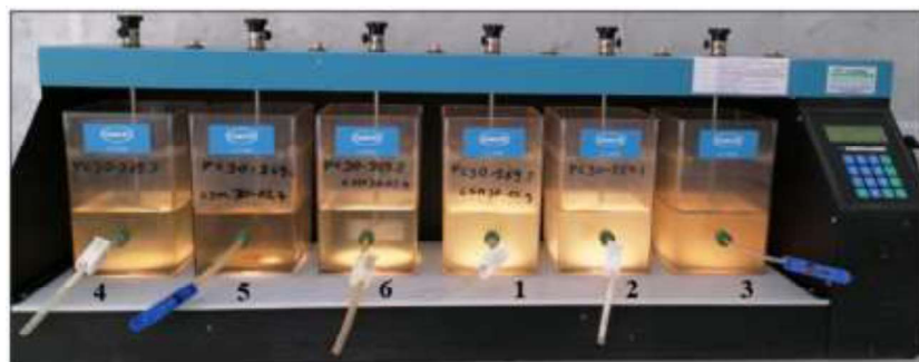
Figura 21. Prueba de jarras (HACH) con la aplicación del coagulante a diferentes concentraciones
