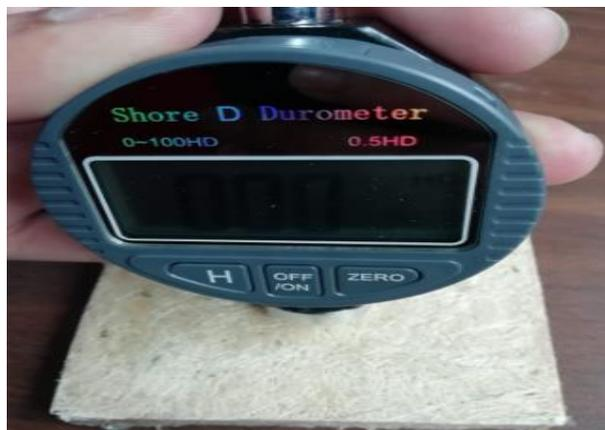
**Figura 30:** Prueba de dureza
