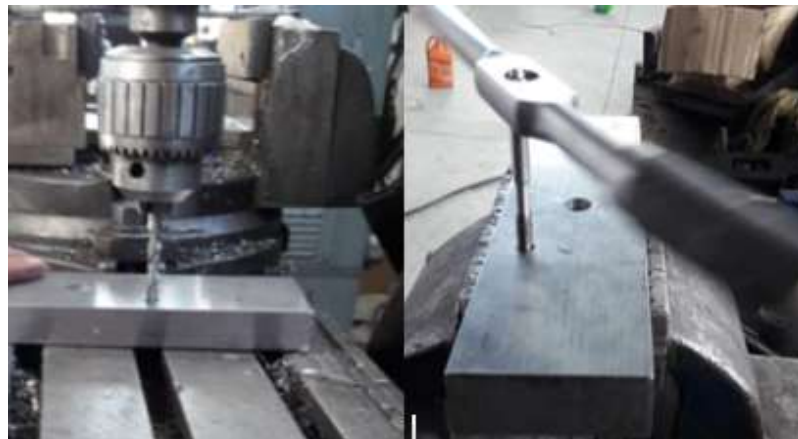
Figura 52: Perforado y roscado de la placa inferior.
