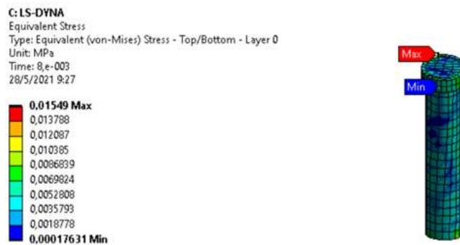
Figura 78: Esfuerzo de Von Mises en el punzón.
