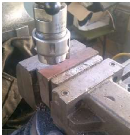
Figura 50: Corte y fresado de la placa inferior.
