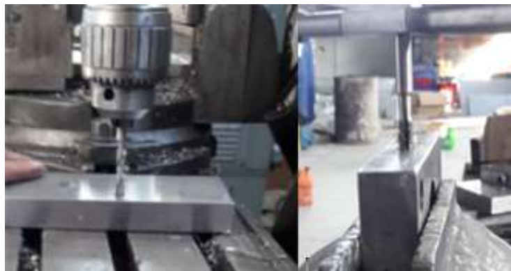
Figura 48: Perforado y roscado del porta matriz.
