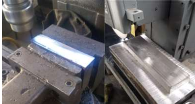
Figura 51: Rectificado de la placa inferior.
