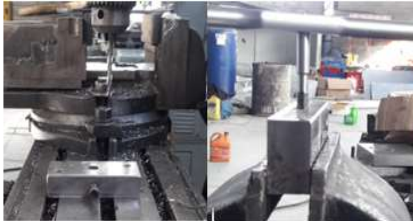
Figura 36: Perforado y roscado del porta punzón.
