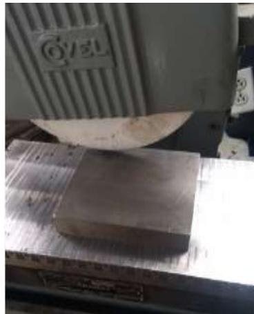
Figura 35: Pieza para rectificar la punta del punzón.
