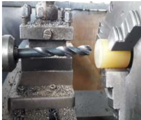
Figura 39: Perforado del anillo botador.
