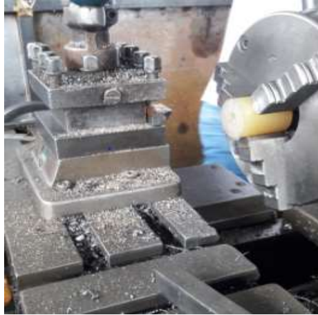
Figura 38: Torneado del anillo botador.
