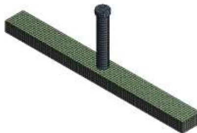
Figura 60: Mallado automático de los elementos.
