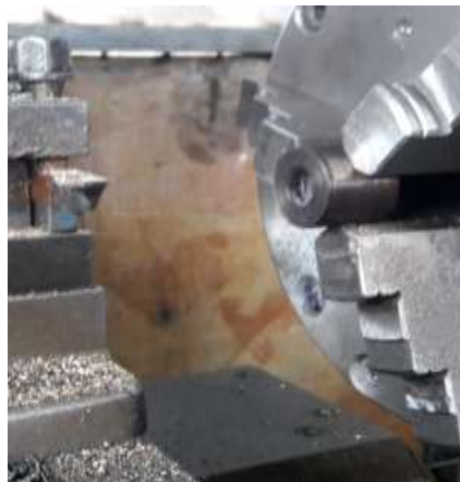
Figura 43: Torneado y corte de las barras de acero.
