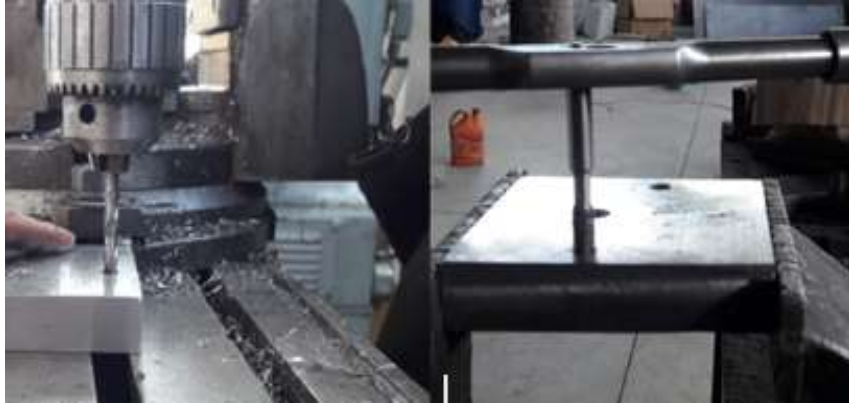
Figura 32: Perforado y roscado de la placa superior.
