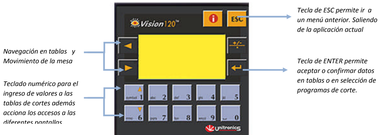
Fig. 26 Vista frontal del panel del OPLC
