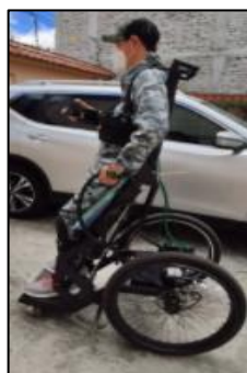
Figura 55. Prueba de sistema de control con bipedestador en plano inclinado
