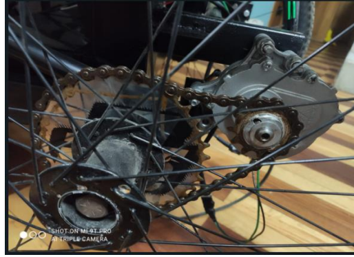
Figura 30. Vista de catalinas y motor ensamblado en la silla de ruedas bipedestadora
