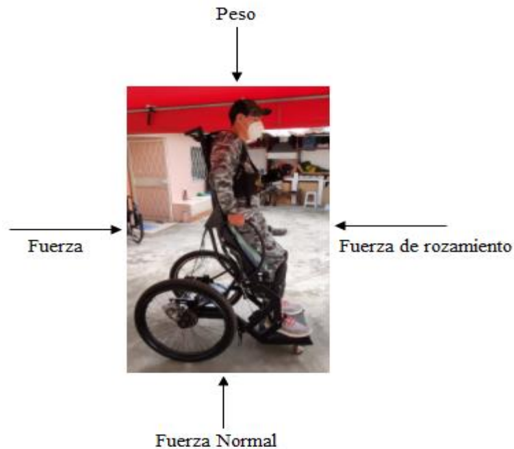
Figura 26. Diagrama de cuerpo libre para el dimensionamiento de potencia del motor en una superficie plana
