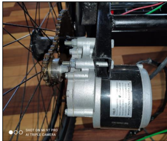
Figura 31. Motor acoplado al mecanismo catalina-cadena
