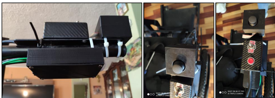
Figura 24. Joystick instalado en la silla de ruedas bipedestadora
