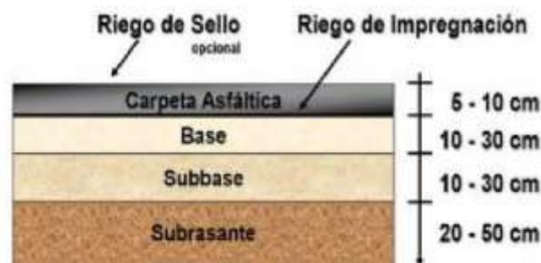
**Gráfico 1.** Estructura de un Pavimento Flexible
