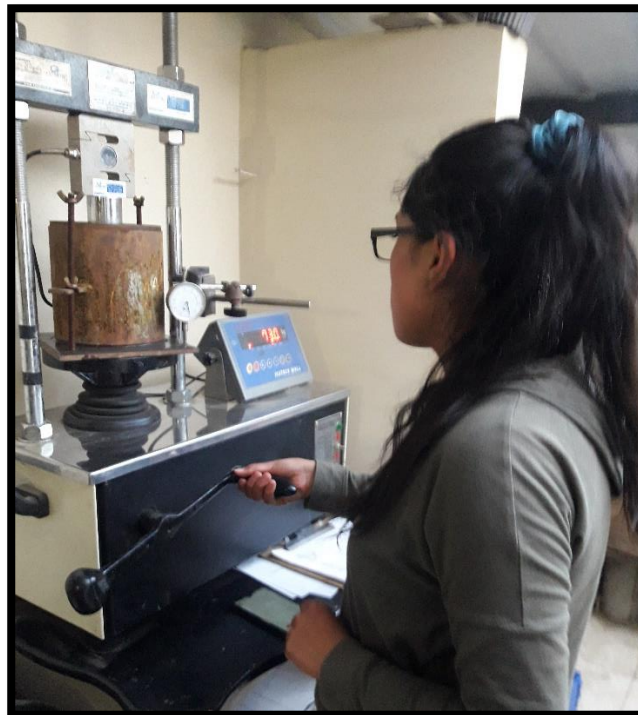
Ensayo de carga penetración
