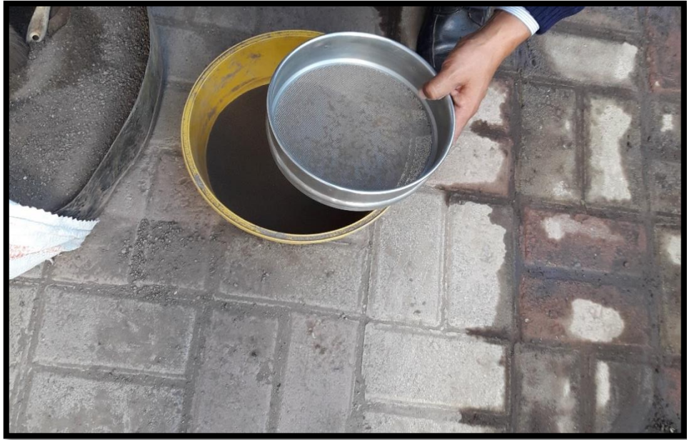
Tamizando la muestra para realizar el ensayo de límites de Atterberg
