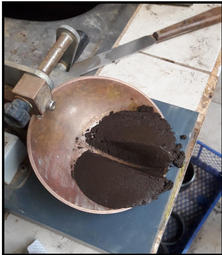
Ensayo de Límite Líquido
