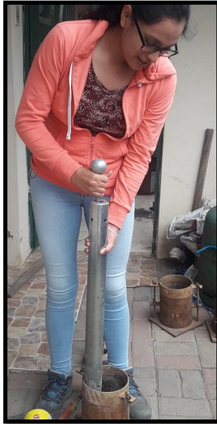
Ensayo de CBR, compactación de suelo
