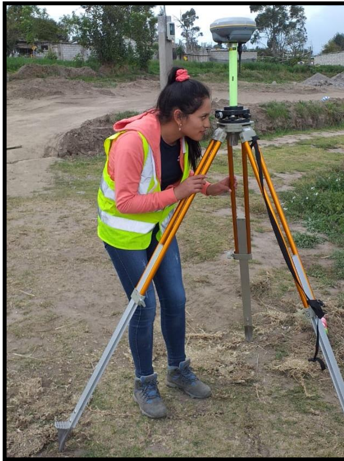
Realización del levantamiento topográfico, calibración de la base del RTK
