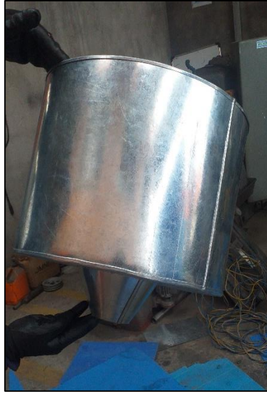
Fabricación del tanque circular a escala.
