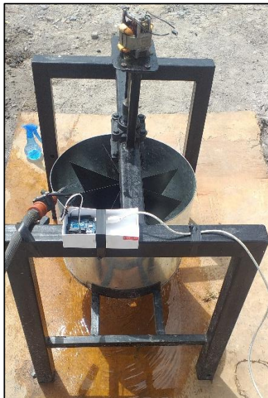
Colocación del generador en el sistema eléctrico a escala.
