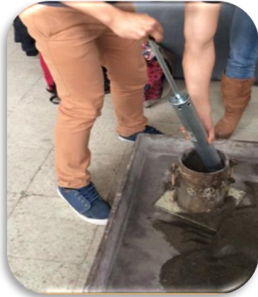
Fotografía 7. Compactación de suelo
