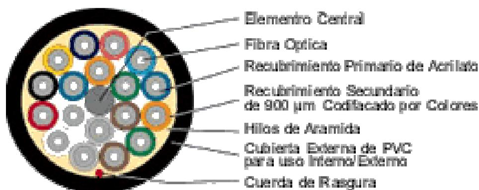
**Figura. 1.10. Características Técnicas en una fibra óptica**
