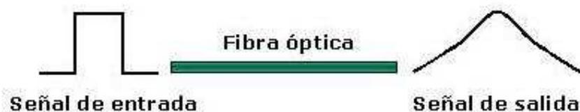
Figura. 1.9. Dispersión en una fibra óptica
