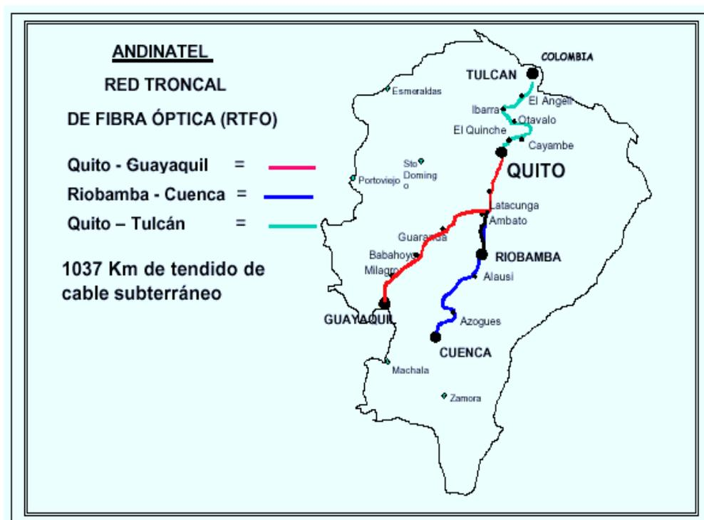
Figura 4.1.Red troncal de Fibra Óptica (RTFO) en el Ecuador
