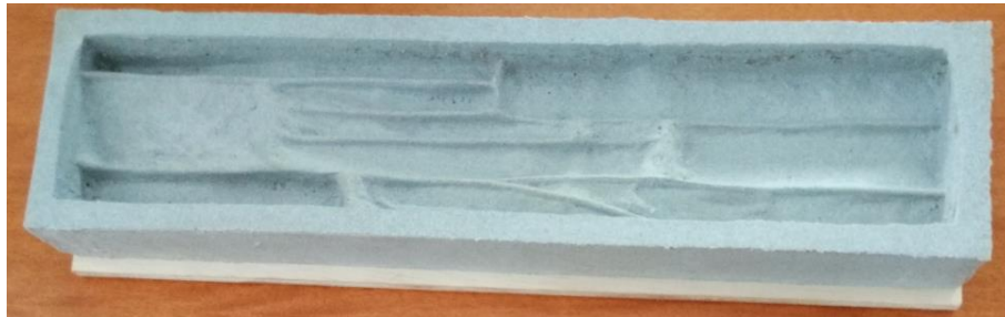
Figura 4.4. Molde a utilizar para fabricación de fachaletas
