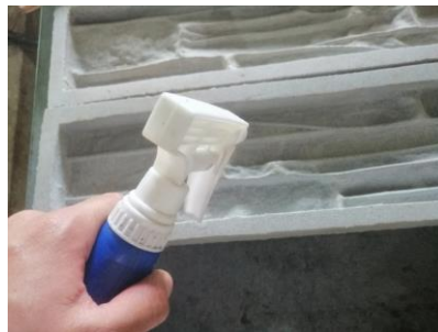
Figura 6.37. Aplicación de la emulsión de silicona (E-11) en el molde de la fachaleta
