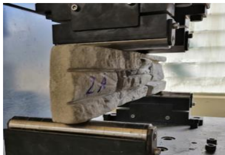
Figura 4.6. Ensayo a flexión de fachaleta a 4 puntos, Norma INEN 2554: 2011
