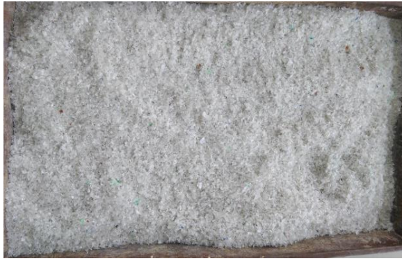
Figura 6.17. Triturado de PET reciclado de 6mm.
