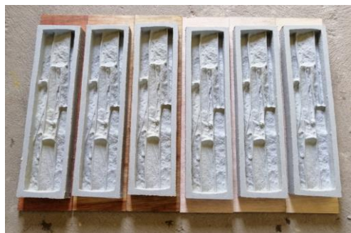
Figura 6.27. Fabricación de 6 moldes de Artesil 1 para la elaboración de fachaletas
