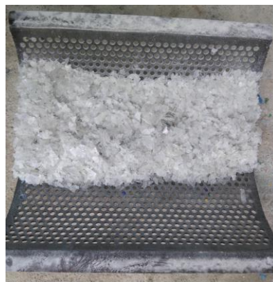
Figura 6.16. Criba utilizada para la obtención de tamaños de tereftalato de polietileno de 6 mm, 8 mm y 14 mm.
