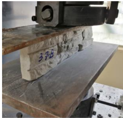
Figura 4.8. Ensayo a compresión de fachaleta, Norma INEN 1573 -2010
