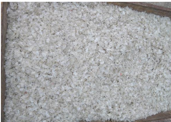
Figura 6.19. Triturado de PET reciclado de 14mm.
