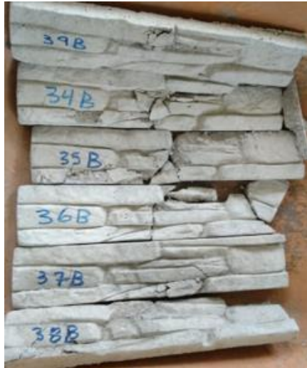
Figura 4.9. Rotura de fachaletas a compresión, combinaciones 39B, 34B, 35B, 36 B, 37B, 38B.
