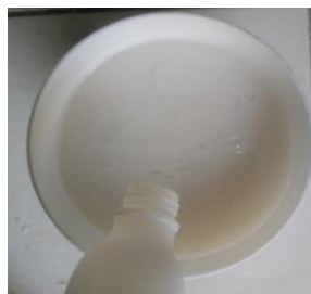
Figura 6.25. Mezcla de Artesil 1 y el catalizador
