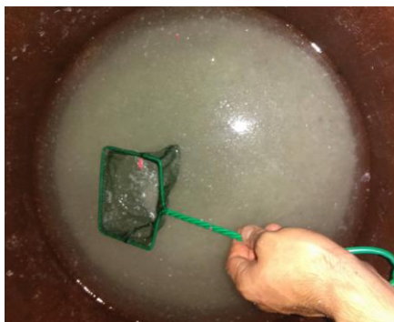
Figura 6.20. Lavado del PET de 6mm, 8mm y 14mm.
