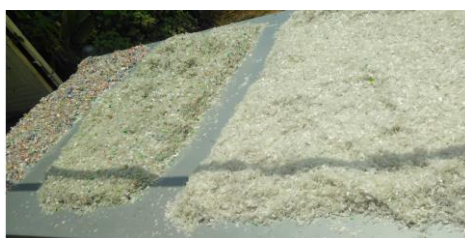
Figura 6.21. Secado del PET de 6 mm, 8mm y 14mm
