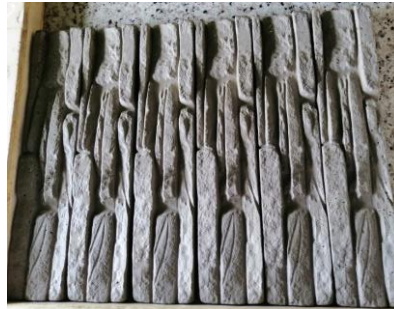
Figura 6.39. Obtención de fachaletas Fuente: Autor
