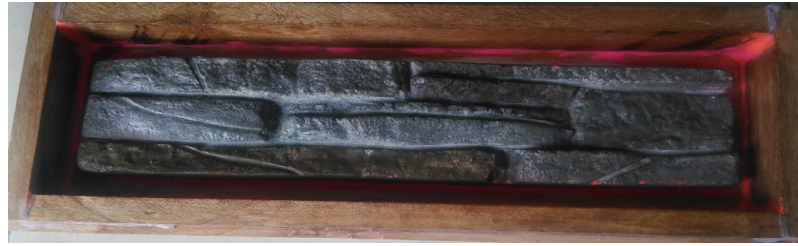
Figura 6.23. Fijación y hermetizado de la estructura del molde para la fachaleta
