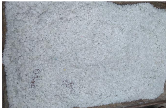
Figura 6.18. Triturado de PET reciclado de 8mm.
