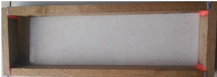
Figura 6.22. Estructura de madera para realizar el molde de la fachaleta
