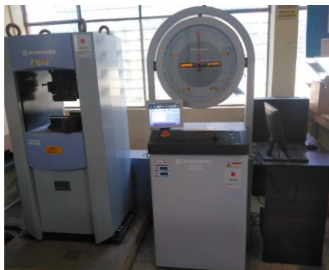
Figura 2.4. Máquina Shimadzu – Concreto 2000x del Laboratorio de Facultad de Civil y Mecánica
