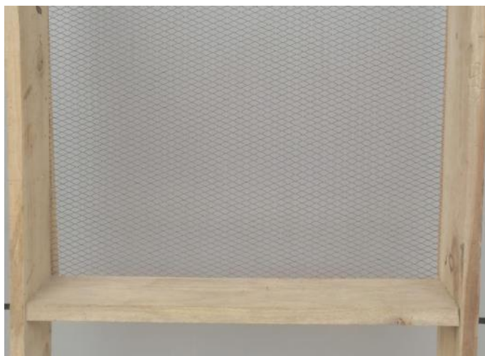
Figura 6.5. Zaranda para obtención del agregado de 8 mm
