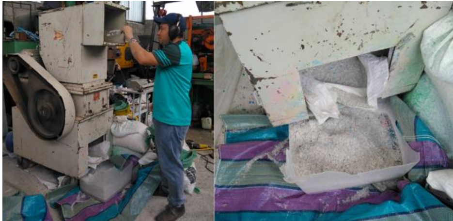
Figura 6.15. Proceso de trituración de las botellas plásticas de PET
