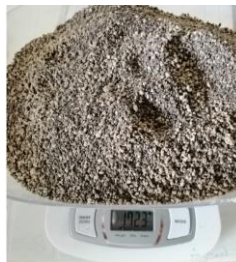
Figura 6.33. Peso de 1723 gramos de agregado de 3mm de la cantera San Joaquín Fuente: Autor
