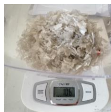
Figura 6.34. Peso de 106 gramos de triturado de PET reciclado de 14 mm Fuente: Autor
