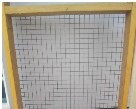
Figura 6.7. Zaranda para obtención del agregado de 11mm.
