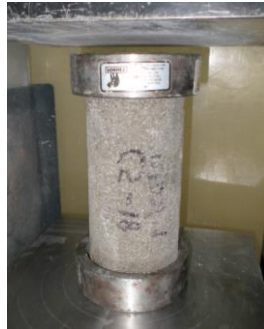
Figura 2.6. Ensayo de compresión en cilindros de concreto
