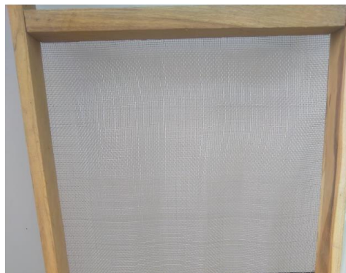
Figura 6.3. Zaranda con tamiz de 3mm x 3mm para obtención del agregado de 3mm
