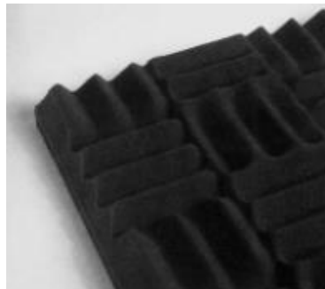
Imagen 68: Plancha del material acústico de espuma de poliuretano. Fuente: Carrión, 1998.
