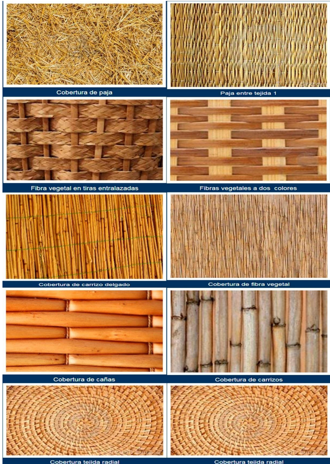
Imagen 28: Tipos de tejidos con fibra vegetal Fuente: Arquitecturas naturales, 2013.
