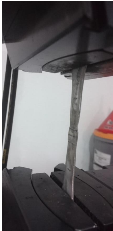
Figura 6-49 Deformación de la probeta antes de romperse. Se puede observar que la ruptura será en cono y copa. Fuente: LenMaV Laboratorio de ensayo de materiales.
