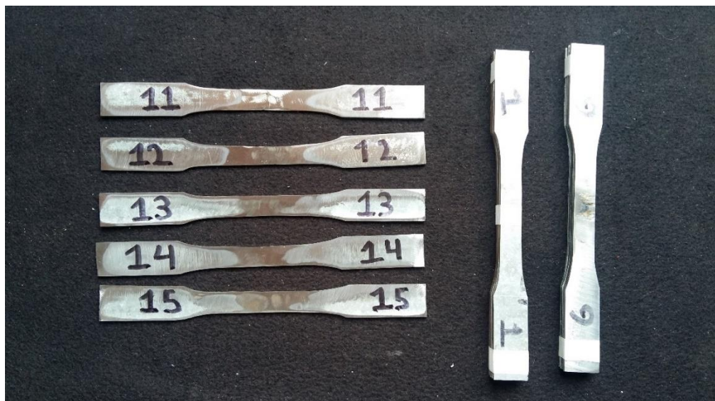
Figura 6-43 Probetas maquinadas por grupo. Fuente: Autor
