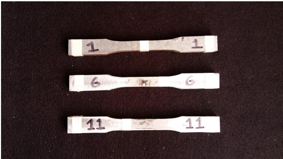
Figura 6-45 Cada grupo de probetas para el ensayo. Fuente: Autor
