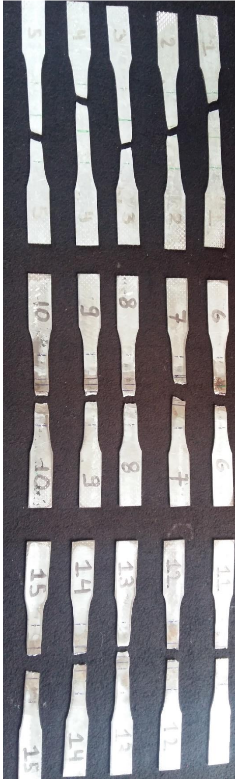
Figura 6-50 Probetas después dl ensayo de tracción Fuente: Autor
