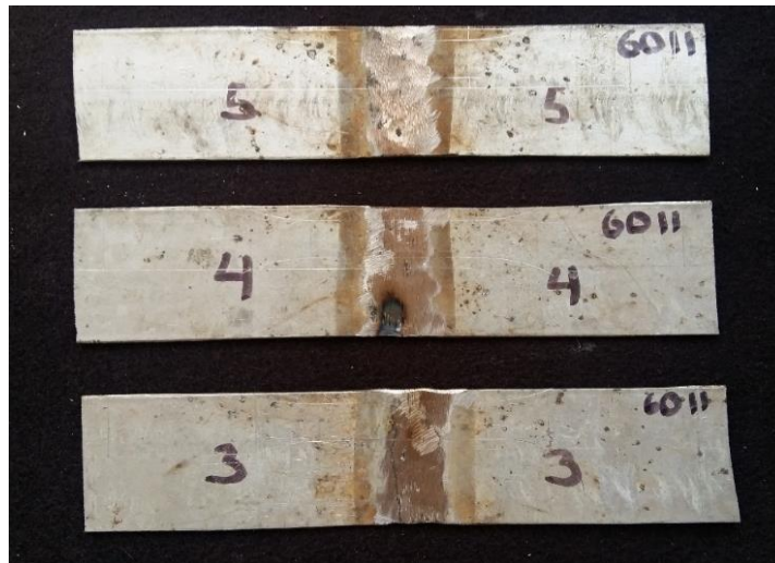
Figura 6-41 Soldadura a tope las placas. Fuente: Autor
