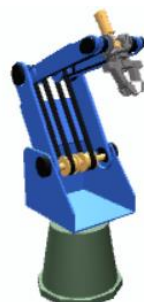
Figura N° 10: Manipulador SCORBOT-ER 4u
